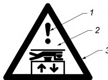
Рисунок 1 — Знак «Опасность снизу — Ограниченное пространство — Соблюдайте осторожность»
