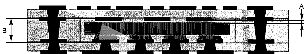
Рисунок 1 — Измеряемые компоненты структуры с микрошлифом отверстия
