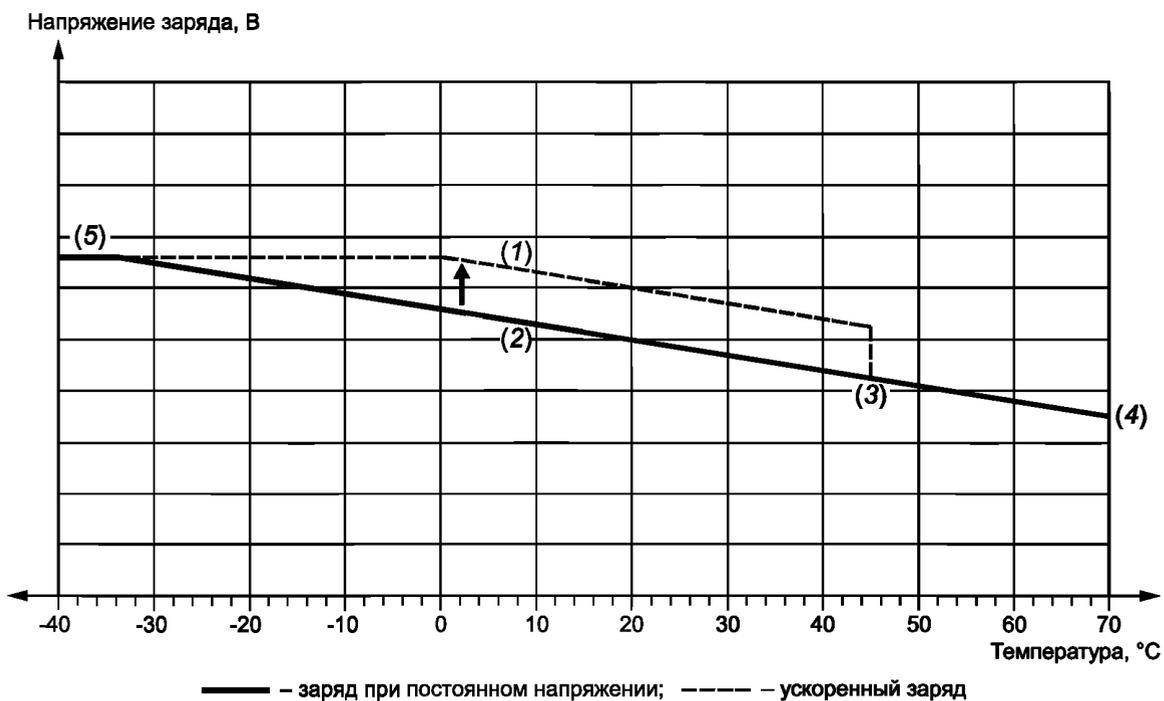
Примечание — На рисунке показан заряд с температурной компенсацией  $3\text{ мВ/}^\circ\text{С/аккумулятор}$ , основанной на  $20\text{ }^\circ\text{С}$  для заряда никель-кадмиевых батарей при постоянном напряжении (один или два уровня) с ограничением значения тока.
