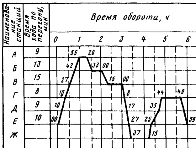
Рис. 8. График работы снегоочистителя по очистке станционных путей на отдельных пунктах (вариант 2)
