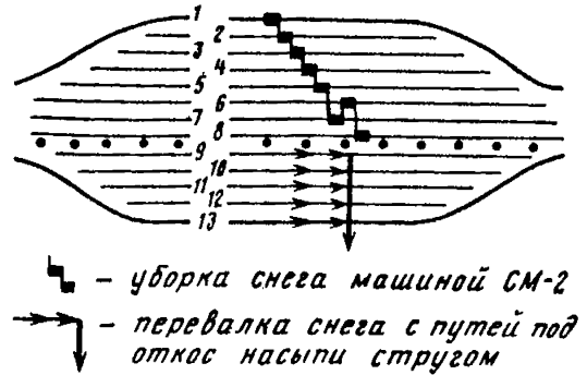
Рис. 9. Схема очистки станции от снега
