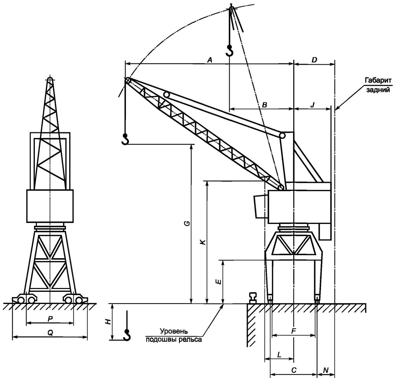
$A$  — максимальный вылет стрелы;  $B$  — минимальный вылет стрелы;  $F$  — колея;  $G$  — максимальная высота подъема груза на крюке от уровня рельсов подкранового пути;  $H$  — максимальная высота опускания груза на крюке ниже уровня рельсов подкранового пути;  $P$  — расстояние между центрами балансирных ходовых тележек;  $Q$  — расстояние между наружными краями балансирных ходовых тележек
