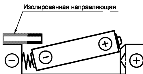
Рисунок В.11 — Один из примеров защищенной установки
