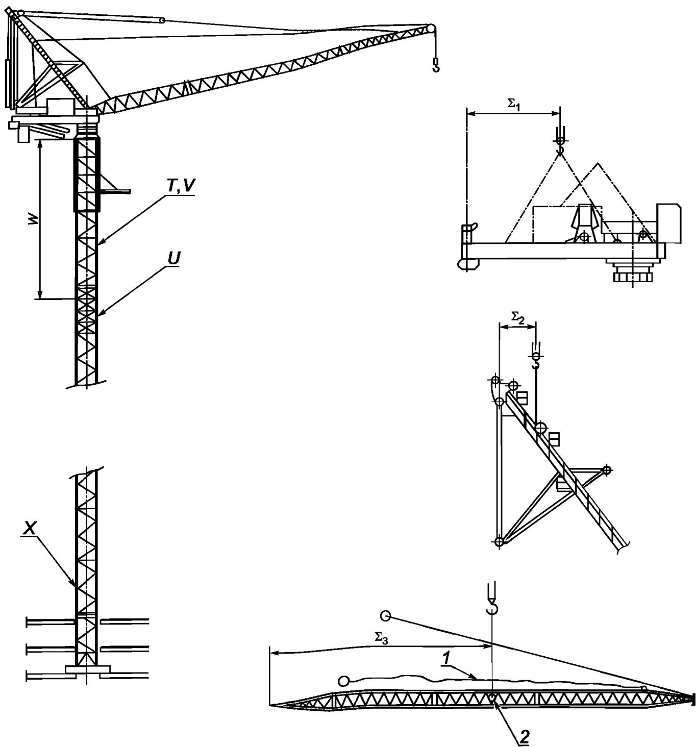
1 — оттяжка при монтаже; 2 — центр тяжести;  $T$  — число секций башни (стандартное);  $U$  — число усиленных секций башни;  $V$  — полные размеры и масса секции башни;  $W$  — максимальный выступ выше несущей балки;  $X$  — данные внутренней подъемной секции и ее масса;  $\Sigma_1$ ,  $\Sigma_2$ ,  $\Sigma_3$  — примеры списка масс компонентов и расположения центров тяжести для целей транспортирования и монтажа
