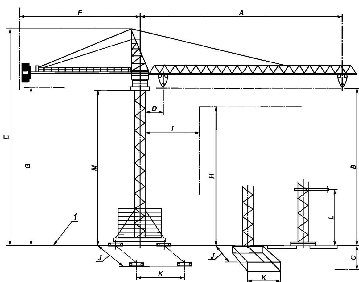
1 — уровень отсчета; А — максимальный вылет; В — максимальная высота подъема; С — глубина опускания; D — минимальный вылет; Е — максимальная высота до верха оголовка; F — задний габарит; G — зазор под противовесной консолью; Н — максимальная высота препятствия; J — колея крана или ширина основания фундамента; К — база крана или длина основания фундамента; I — минимальное расстояние до препятствия; L — максимальная высота свободно стоящей башни; М — расстояние до нижнего крепления башни
