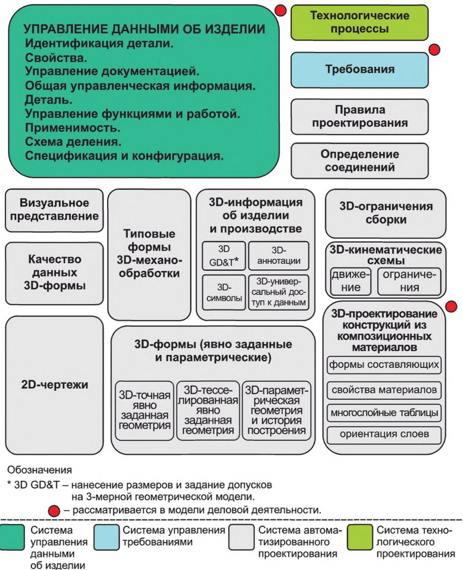
Рисунок 2 — Обзор информационной модели для управляемого проектирования на основе трехмерной модели
