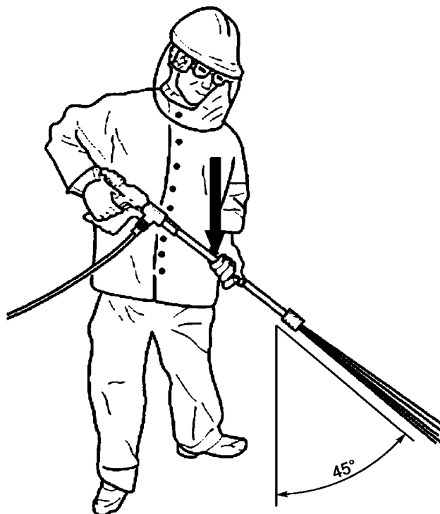
Рисунок DD.5 — Рабочие условия. Положение пистолета-распылителя
