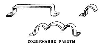
1. Изготовить скобу: разметить листовую сталь голщиной 1-2 мм, отрезать полосы и нарезать заготовки, выправить, зачистить заусенцы, набрать комплект валиков (фасонная скоба), согнуть заготовку по форме, закруглить концы лапок, пробить отверстия.
