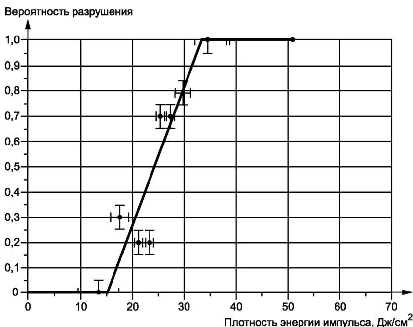
Рисунок В.3 — График распределения вероятности разрушения, значение ПЛР 15,1 Дж/см<sup>2</sup>
