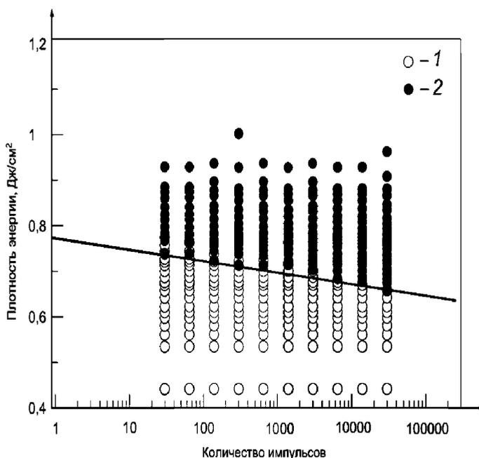
1 — участки без разрушения; 2 — участки с разрушением
