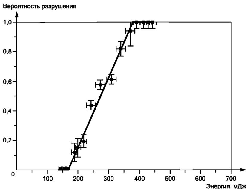
Примечание — Условия испытаний:  $d_{86,5} = 1,44$  мм,  $\lambda = 10,6$  мкм,  $\tau_u = 100$  нс, хвостовая часть = 3,5 мкс (лазер TEA CO<sub>2</sub>); образцы: KBr окна, 50 шт. диаметром 40 мм.
