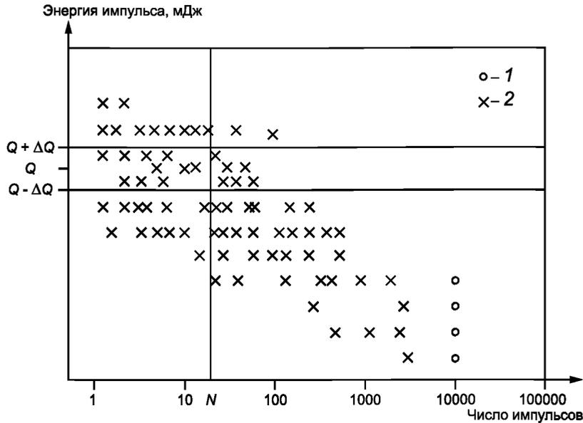
$N$  — число импульсов; 1 — без разрушения; 2 — с разрушением
