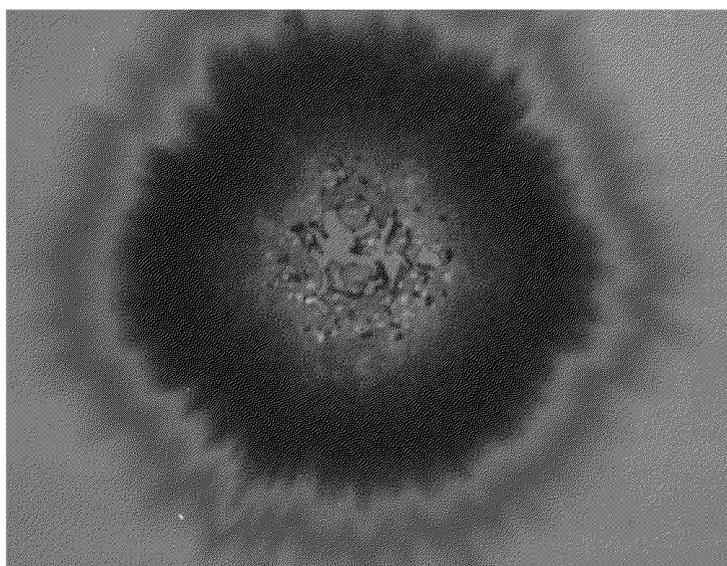
Примечание — Разрушение, вызванное включениями в покрытии. Разрушения вызываются поглощением на более высоких уровнях плотности энергии.
