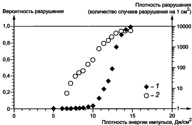
1 — вероятность разрушения; 2 — плотность разрушения
