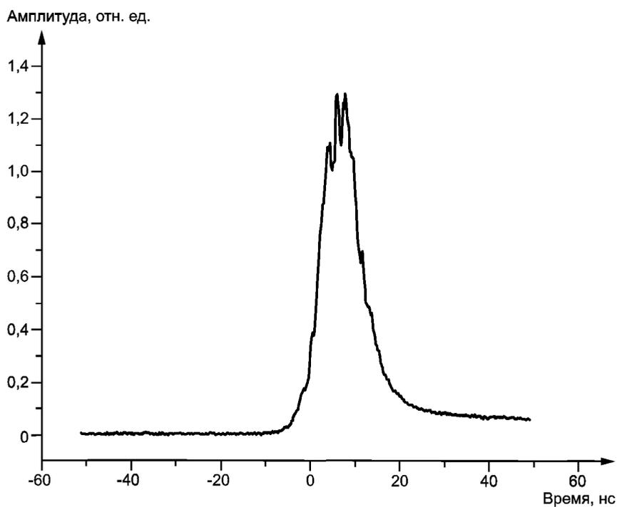
Примечание — Длительность импульса (FWHM) — 10 нс; длительность импульса (эффективная) — 11 нс.
