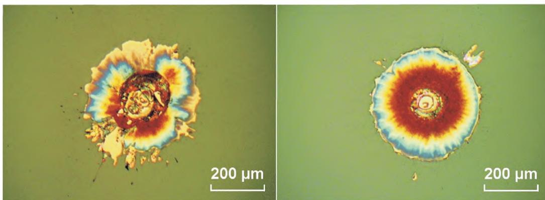
а) Разрушение покрытия образца 1 в положении 95 (плотность энергии 60,1 Дж/см<sup>2</sup>, повреждение после пяти импульсов)
