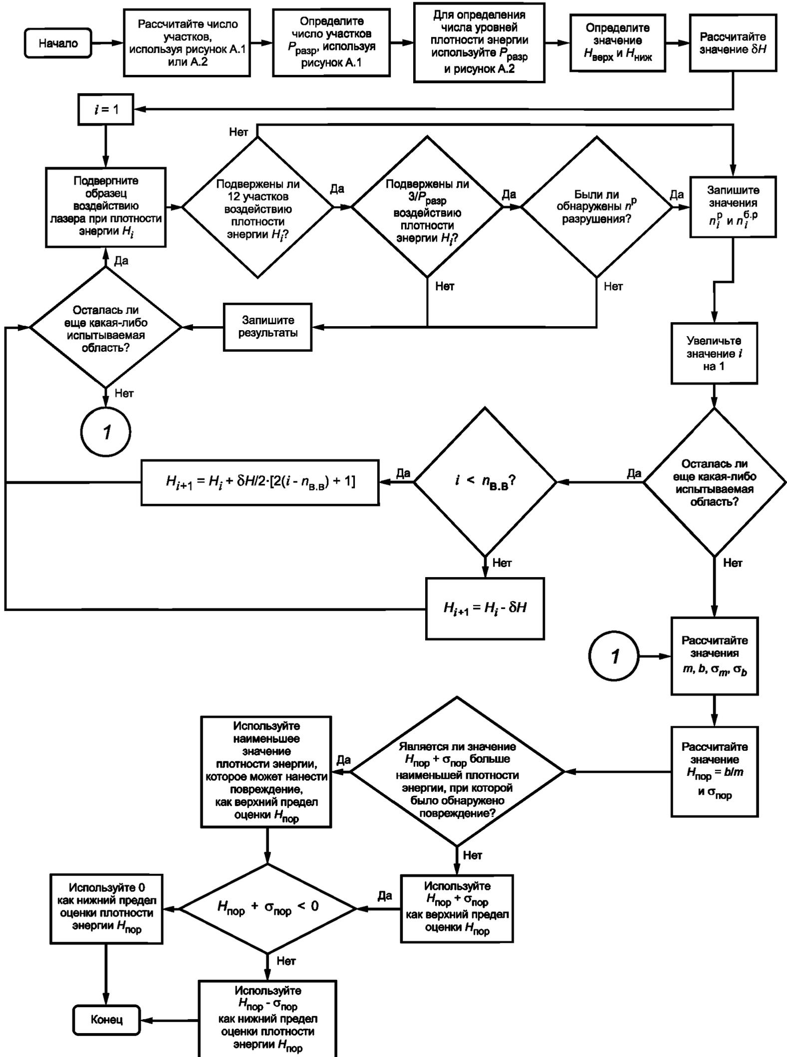
Рисунок А.3 — Блок-схема для испытаний
