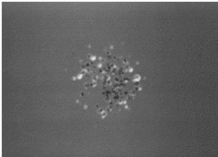
Примечание — Разрушение, вызванное включениями в покрытии. Разрушения вызываются поглощением на более высоких уровнях плотности энергии.
