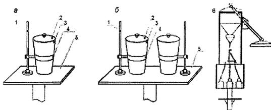
а – установка для отбора суммарных проб АО; б – установка для отбора суммарных и единичных проб; в – автоматический пробоотборник;
