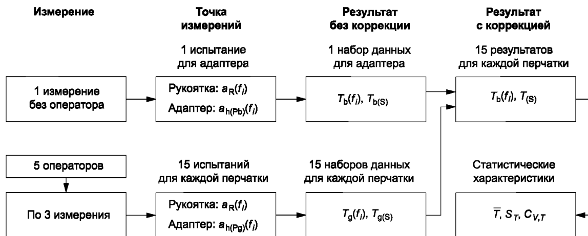
Рисунок 10 — Блок-схема определения среднего корректированного коэффициента передачи перчатки, его стандартного отклонения и коэффициента вариации
