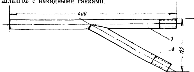
Рис. 8. Ороситель-туманообразователь конструкции Пигарева
