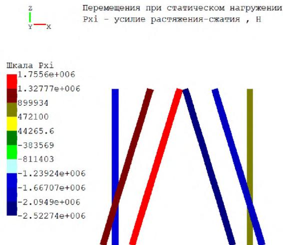
Рисунок И.10 – Значения продольных сил в сваях
