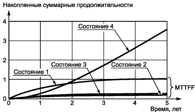
Рисунок 27 — График зависимости от времени Ast_i(t_1, t_2) для марковской модели, представленной на рисунке 24
