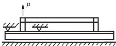
Рисунок 9 — Схема определения прочности соединения стоек правил и полутерков с основанием
