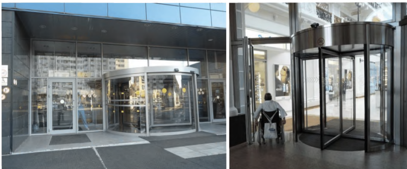
Рисунок 6.67 – Примеры применения вращающихся дверей с дублирующим проходом через распашную дверь
