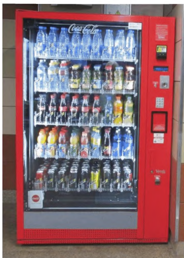
Приемник купюр находится вне зоны досягаемости инвалида на кресле-коляске
