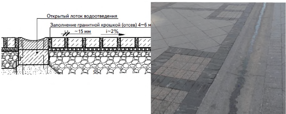
Рисунок 5.25 – Открытые лотки глубиной не более 0,04 м и с пологими краями
