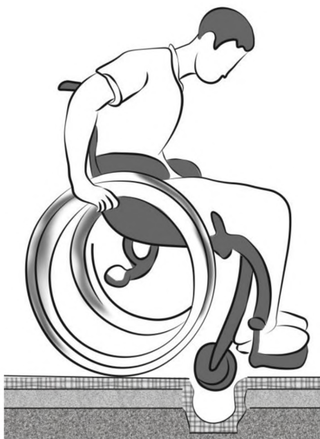
Рисунок 5.26 – Глубокие узкие открытые лотки на путях движения инвалидов недопустимы
