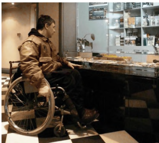
Рисунок 7.24 – Универсальные прилавки обслуживания с учетом удобства, как стоящих клиентов, так и в кресле-коляске
