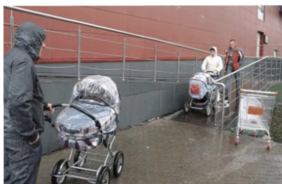
Рисунок 6.27 – При интенсивном движении предпочтительны широкие пологие пандусы, обеспечивающие возможность двустороннего движения
