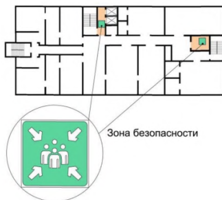
Рисунок 10.29 – Обозначение зоны безопасности на плане здания
