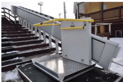
Рисунок 6.48 – Примеры применения подъемных платформ на входных группах объектов обслуживания
