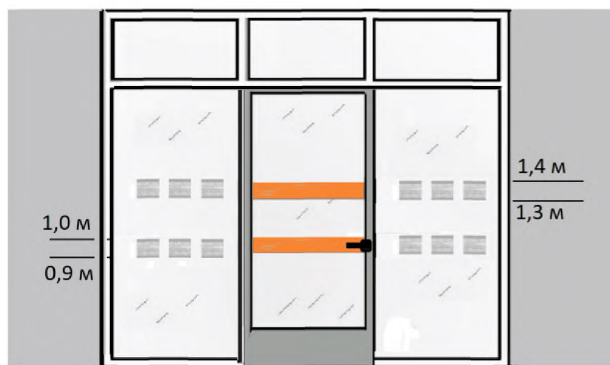
Рисунок 6.63 – Высота размещения контрастной маркировки стеклянных поверхностей
