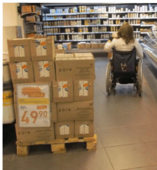
Рисунок 7.3 – Недопустимо сужение проходов за счет временного складирования товаров в ящиках и на паллетах
