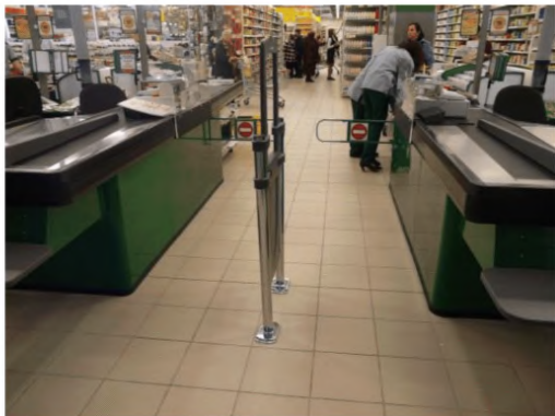
Рисунок 7.18 – Узкий проход, недоступный для инвалида на кресле-коляске
