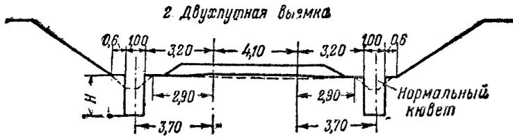
Фиг. 21. Расположение продольного лотка в двухпутной выемке
