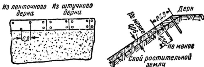
Фиг. 146. Укрепление бровки насыпей дерновой лентой
