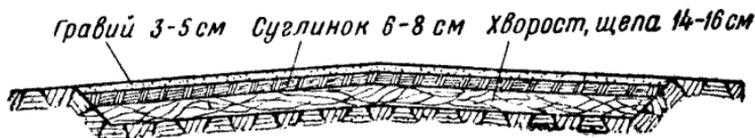
Фиг. 33. Укрепление проезжей части временки
