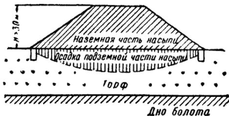
Фиг. 59. Схема возведения насыпи высотой 3 м и более на болотах первого типа высотой до 0,5 м разрешается оставлять в основании насыпи.
