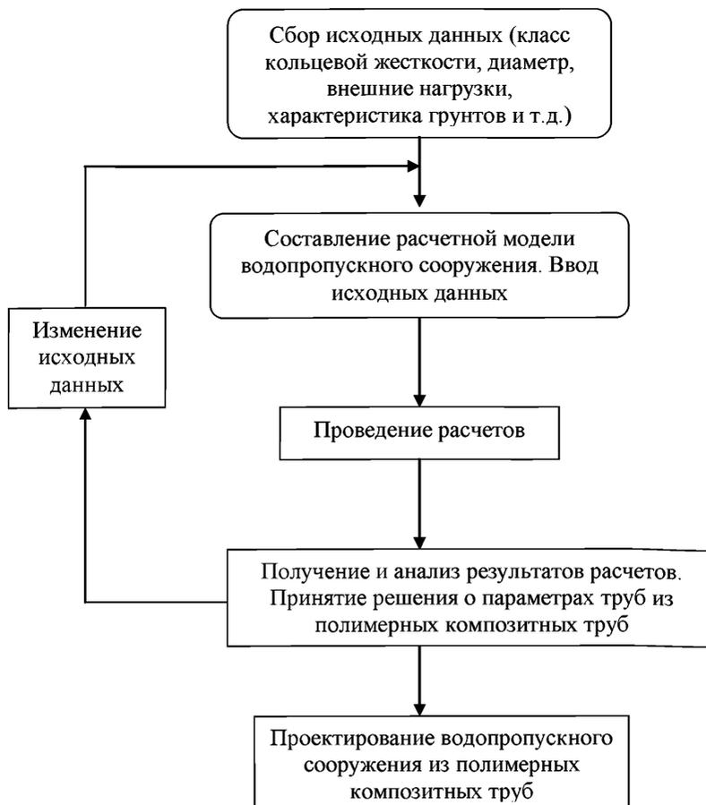
Рисунок Б.1 – Блок-схема определения относительных деформаций полимерных композитных труб под насыпью автомобильной дороги
