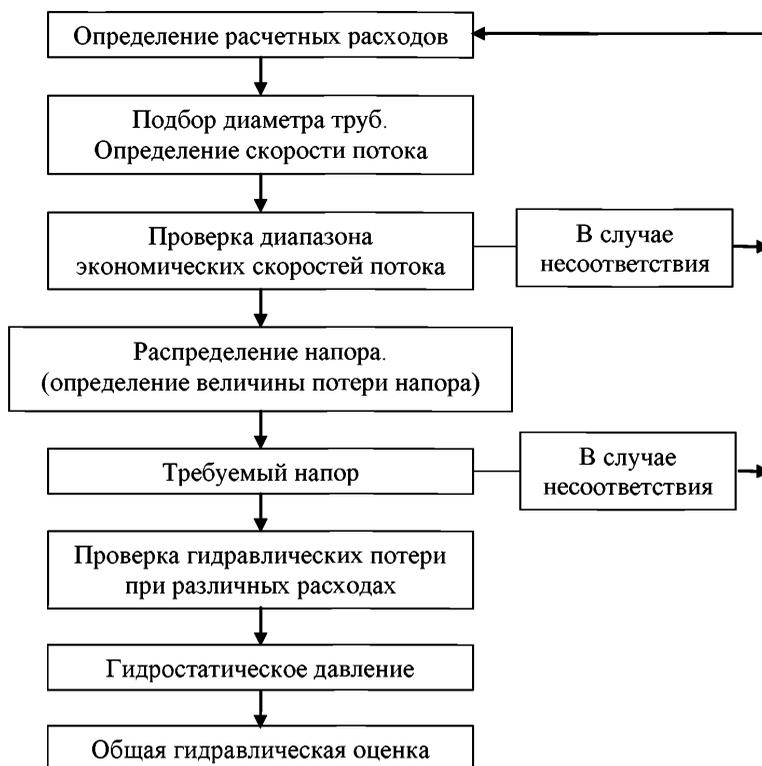
Рисунок В.1 – Алгоритм гидравлического расчета
