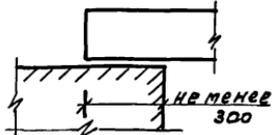
1. Укладку арболитовой смеси производить на свежесложенный бетон.
