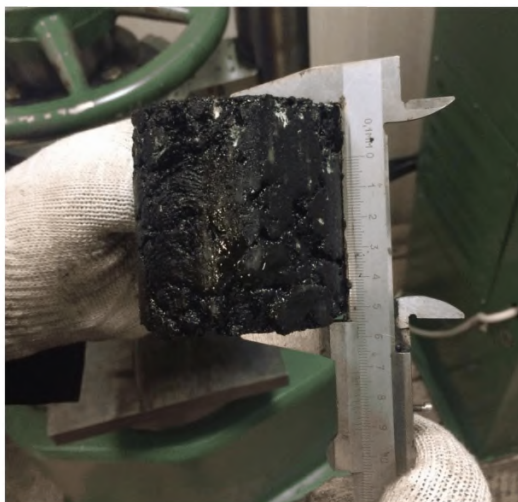
Рисунок 9 – Измерение асфальтобетонного образца штангенциркулем
