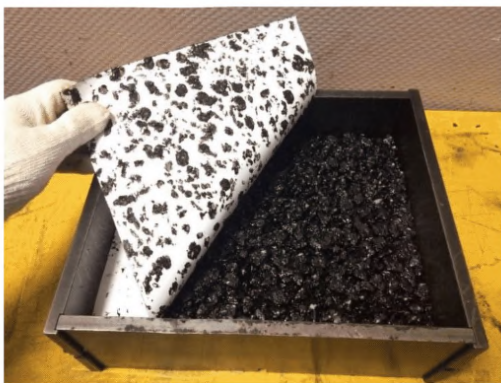
Рисунок - 25 Форма с образцом после проведения уплотнения
