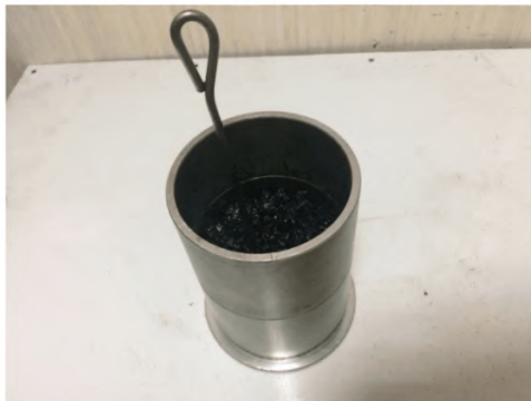
Рисунок 17 – Форма для приготовления лабораторных асфальтобетонных образцов со смесью и металлическим стержнем
