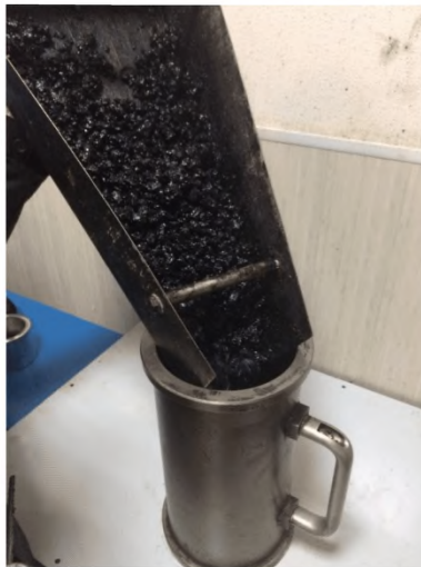
Рисунок 29 – Асфальтобетонную смесь засыпают в форму при помощи специального лотка за один прием
