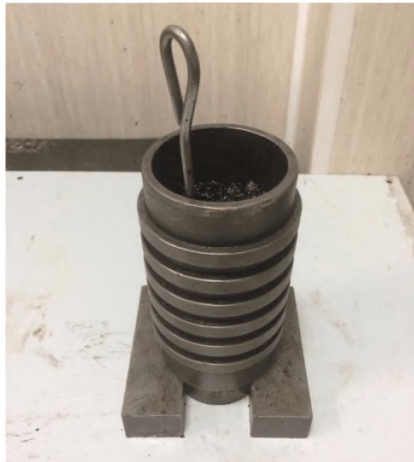
Рисунок 5 – Металлический стержень для штыкования в форме со смесью
