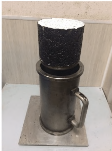
Рисунок 30 – Извлечение асфальтобетонного образца при помощи выжимного устройства
