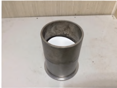
Рисунок 18 – Форма для приготовления лабораторных асфальтобетонных образцов с листом неабсорбирующей бумаги над смесью
