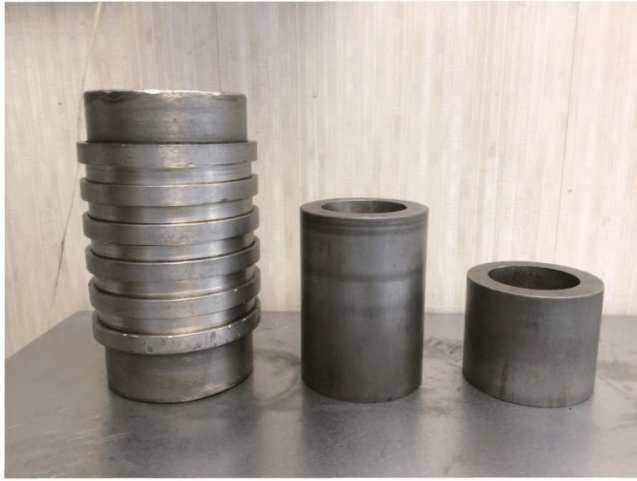
Рисунок 2 – Цилиндрическая форма диаметром 71,4 и два вкладыша, предназначенная для приготовления асфальтобетонных образцов из мелкозернистых и щебёночно-мастичных асфальтобетонных смесей
