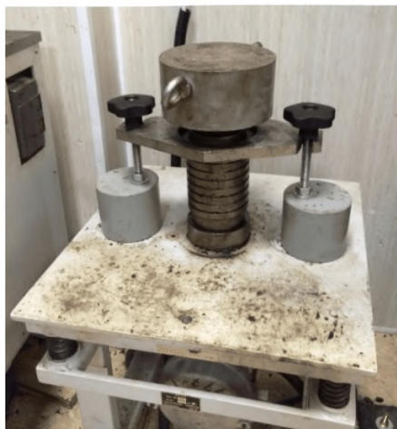
Рисунок 8 – Виброплощадка для предварительного уплотнения многощебенистых смесей
