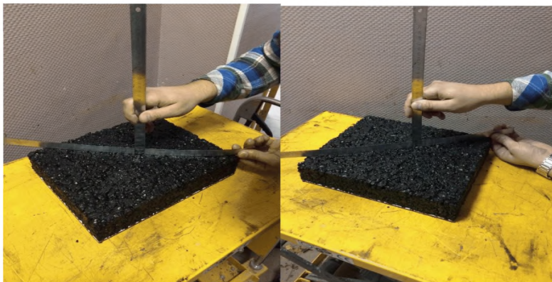
Рисунок - 28 Определение ровности образца-плиты во взаимно-перпендикулярных плоскостях
