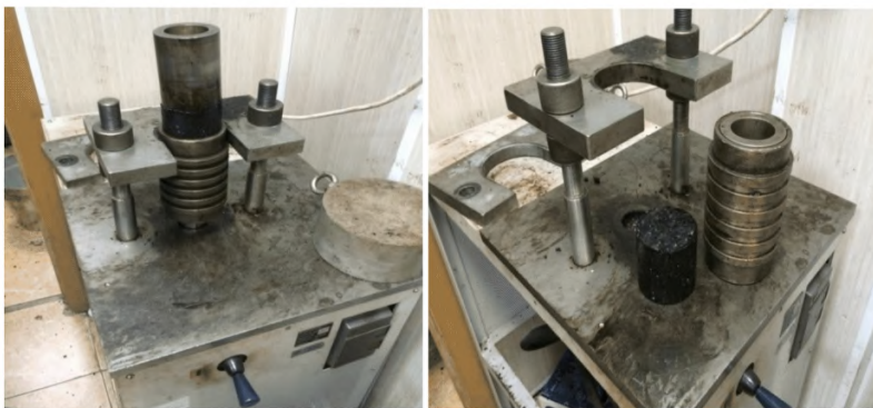
Рисунок 7 – Выжимное устройство для извлечения образцов из форм
