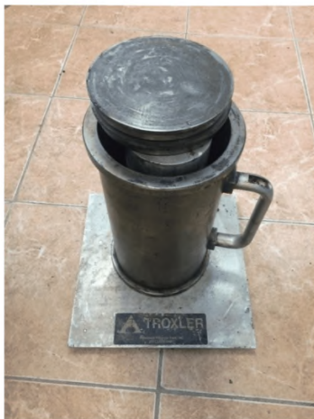
Рисунок - 31 Стальная форма с вкладышами, для приготовления образцов диаметром 150 мм.
