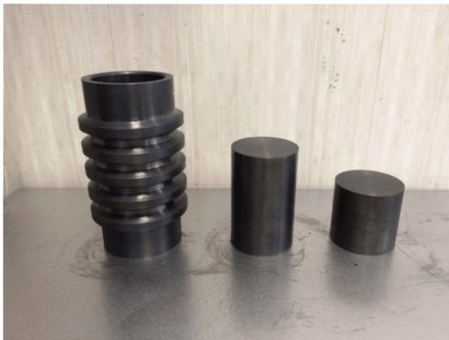
Рисунок 1 – Цилиндрическая форма диаметром 50,5 мм и два вкладыша, предназначенная для приготовления асфальтобетонных образцов из песчаных смесей
