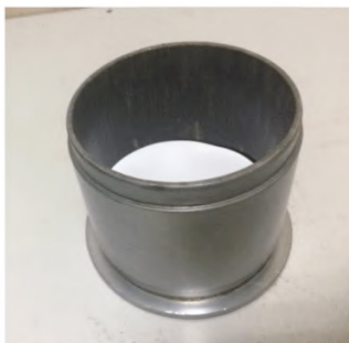
Рисунок 16 – Форма для приготовления лабораторных асфальтобетонных образцов с листом неабсорбирующей бумаги
