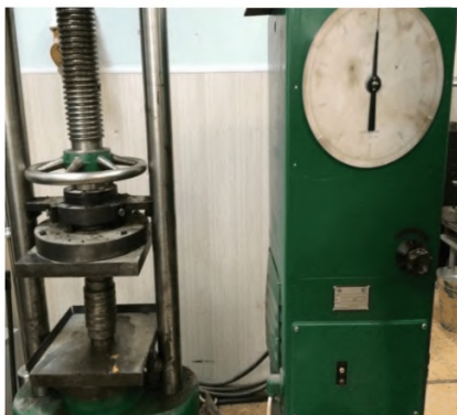
Рисунок 6 – Уплотнение асфальтобетонной смеси на прессе П-50
