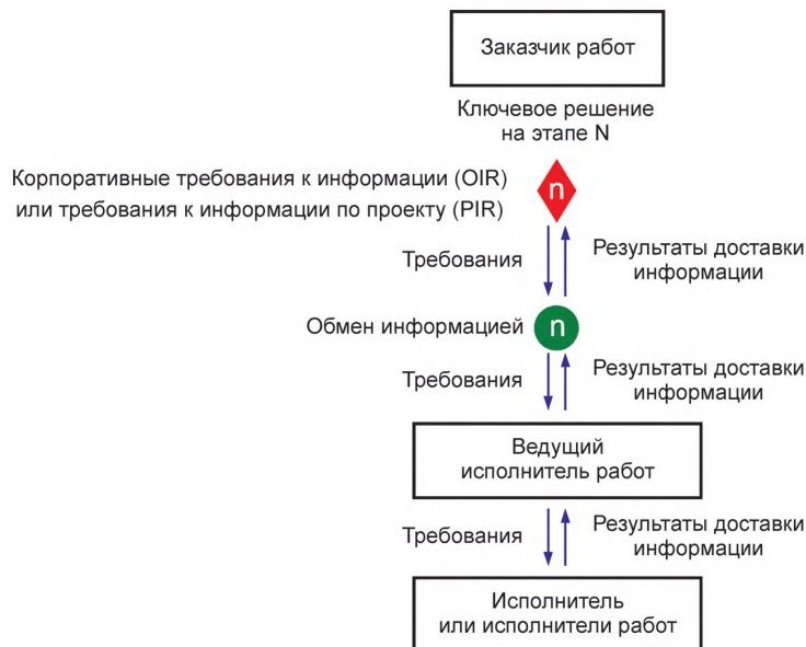
Рисунок 6 — Связь между точкой принятия ключевого решения и информацией от ведущего исполнителя работ
