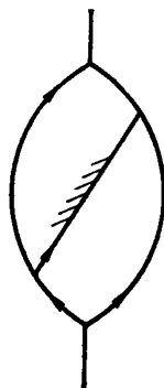
Рис. 7. Схема вентиляционных соединений с диагональю, содержащей выемочный участок
