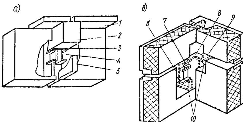
**Рис. 2. Несущие стальные закладные детали в панелях наружных стен домов серии 1-335**
