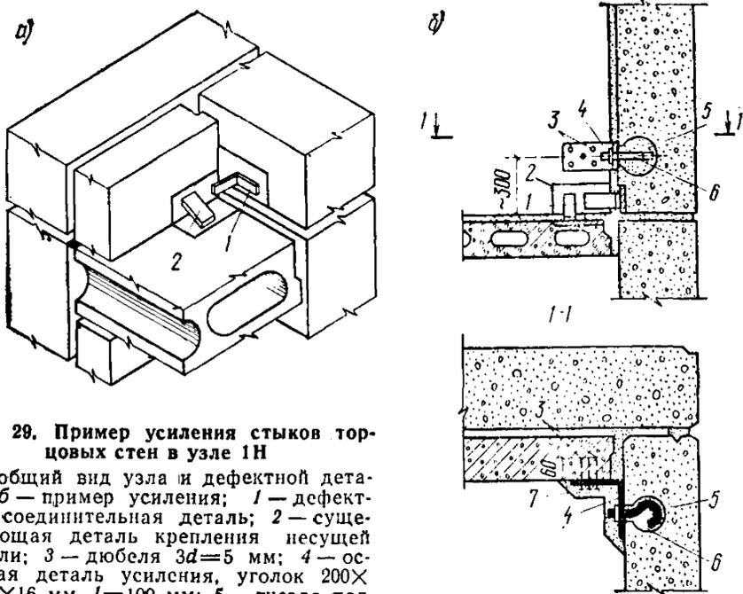
Рис. 29. Пример усиления стыков торцовых стен в узле 1Н
