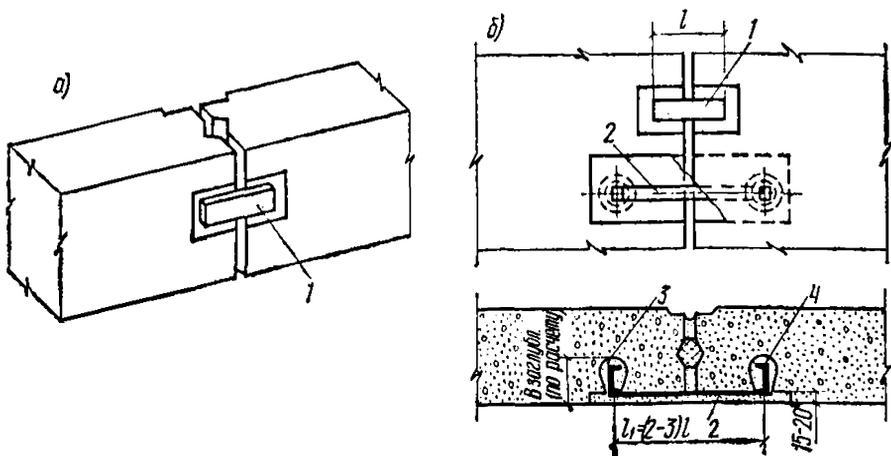
Рис. 28. Усиление узла соединения наружных панелей в домах серии 1-468
