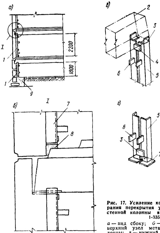
Рис. 17. Усиление конструкции опирания перекрытия установкой пристенной колонны в домах серии 1-335
