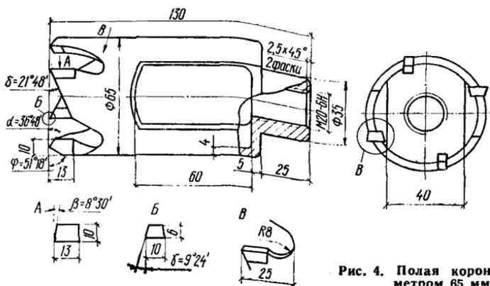
Рис. 4. Полая коронка диаметром 65 мм
