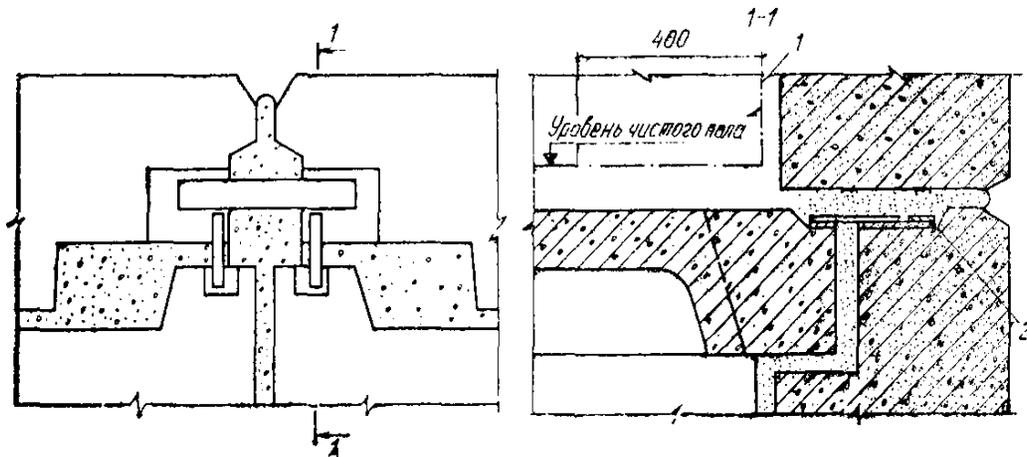
**Рис. 9. Узел соединения наружных панелей с панелями перекрытий в рядовом стыке домов серии 1ЛГ-507**
