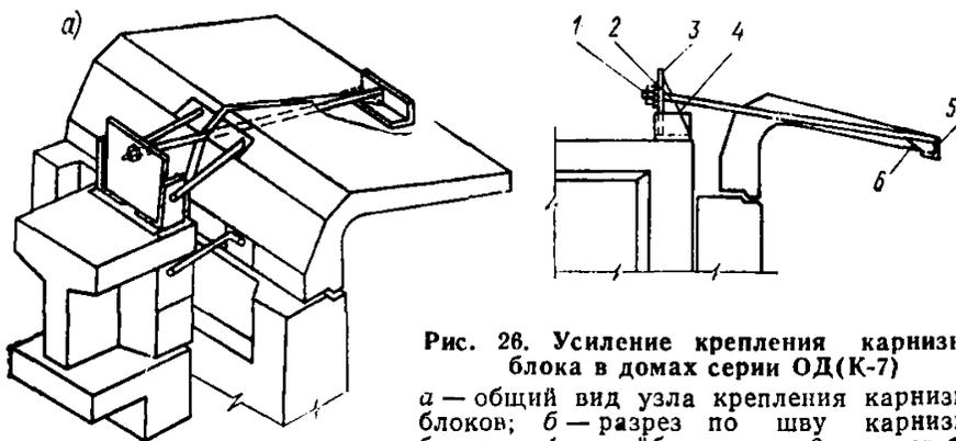
**Рис. 26. Усиление крепления карнизного блока в домах серии ОД(К-7)**
