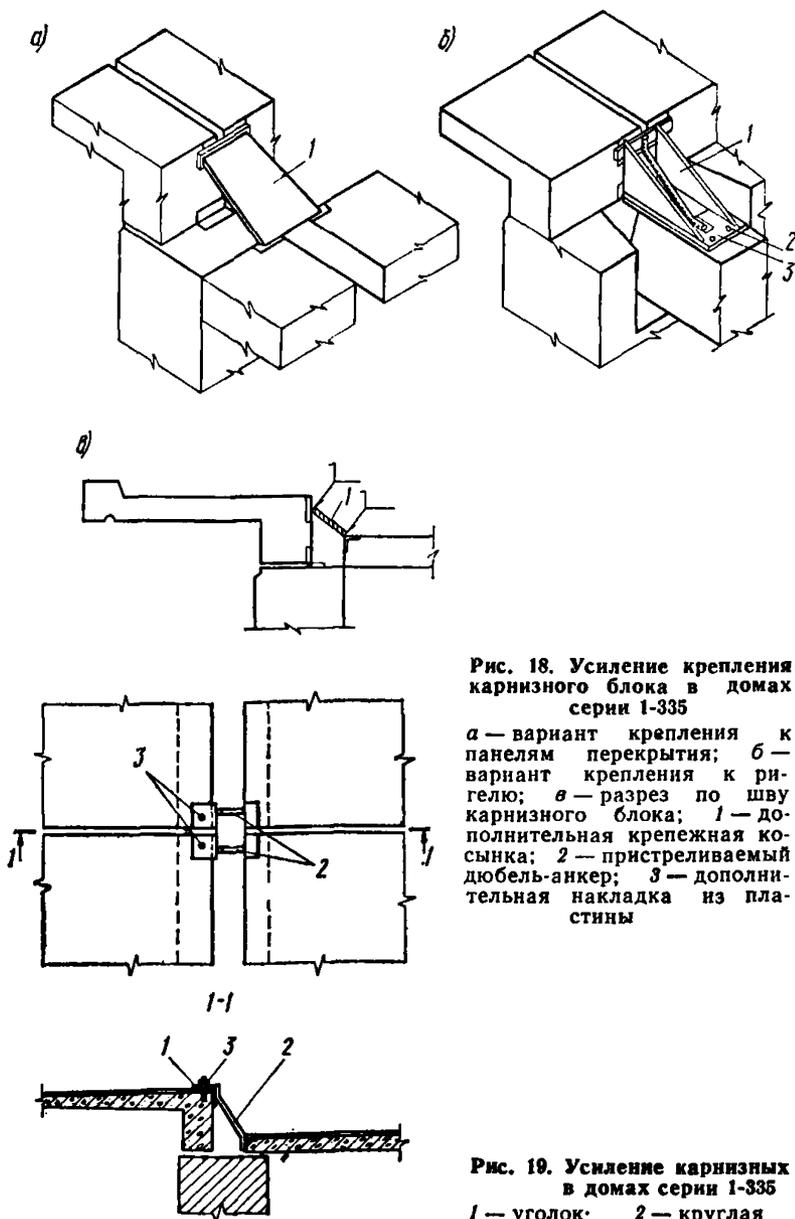
Рис. 18. Усиление крепления карнизного блока в домах серии 1-335
