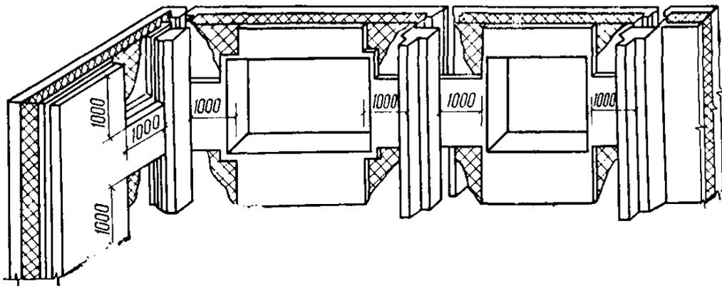
Рис. 21. Места закладных деталей и связей в наружных стенах и размеры выемки при их усилении в домах серии ОД(К-7)
