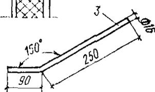
2) если закладные детали карнизного блока нельзя использовать для крепления новых связей, создают новую конструкцию крепления (рис. 26).
