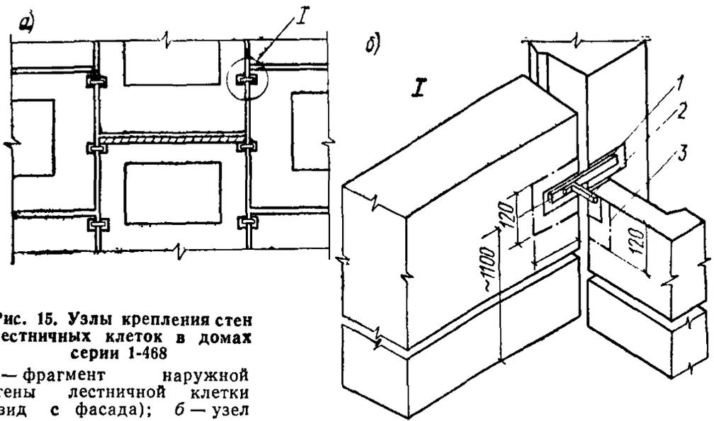
**Рис. 15. Узлы крепления стен
