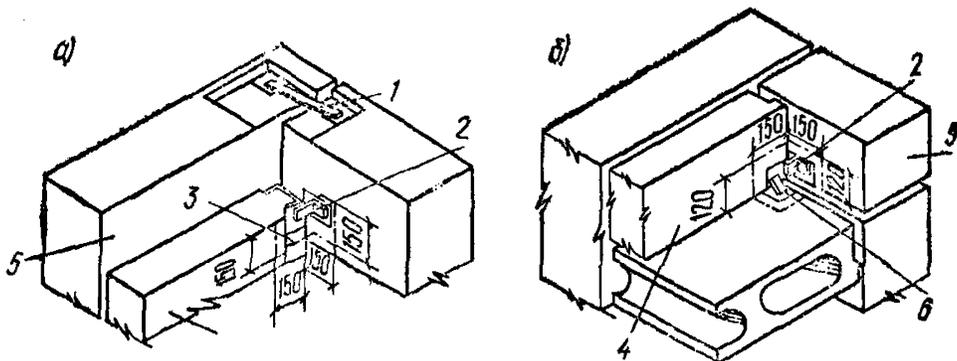
**Рис. 14. Узлы крепления угловых стыков в домах серии 1-468**
