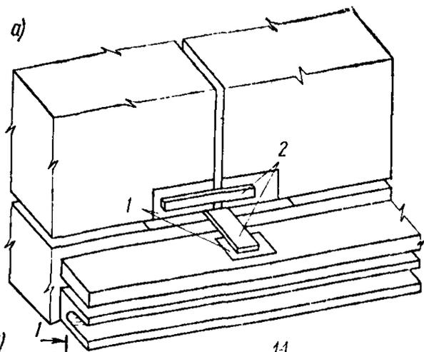
Рис. 30. Усиление узла соединения наружных панелей и перекрытия в домах серии 1-468
