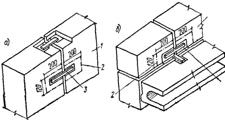
**Рис. 12. Узлы соединений рядовых фасадных стен домов серии 1-468**
