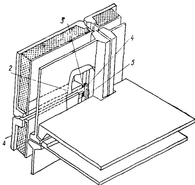
**Рис. 24. Усиление крепления навесных панелей торцовых стен (вариант приварки дополнительных связей) в домах серии ОД(К-7)**
