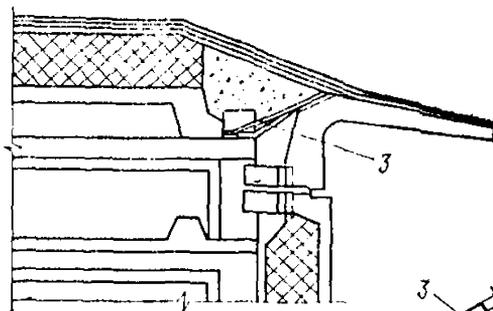
**Рис. 25. Укрепление карнизных блоков приваркой новых металлических связей**
