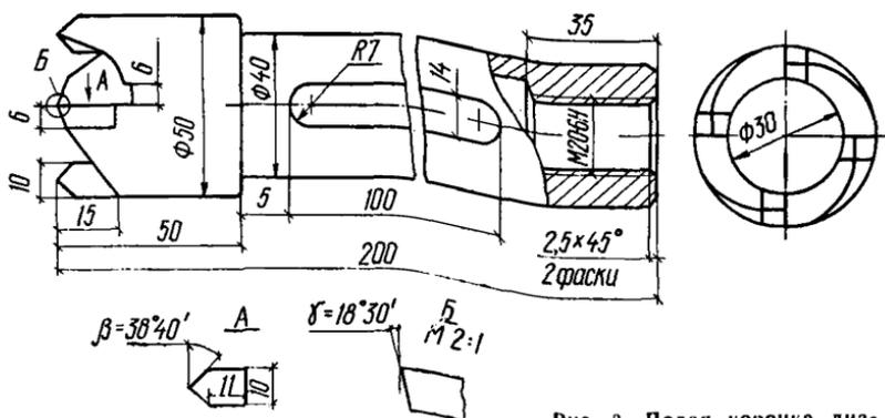
Рис. 3. Полая коронка диаметром 50 мм
