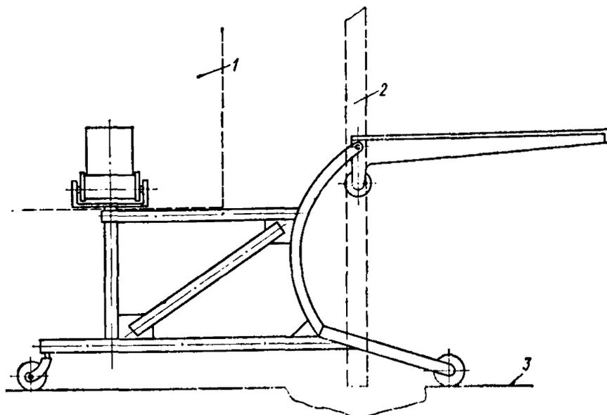
**Рис. 1. Тележка в момент приема колонны в проем окна**
