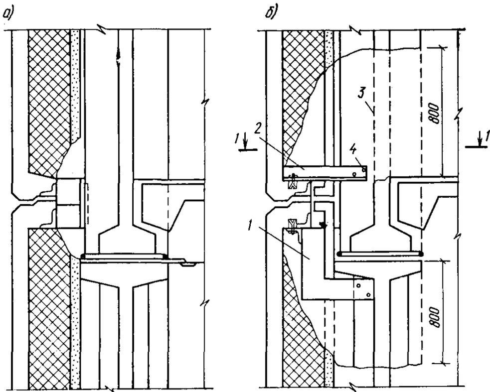
Рис. 20. Усиление крепления навесных панелей торцовых стен в домах серии ОД(К-7)
