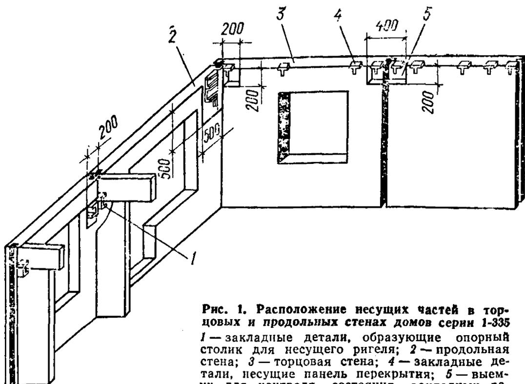
**Рис. 1. Расположение несущих частей в торцовых и продольных стенах домов серии 1-335**
