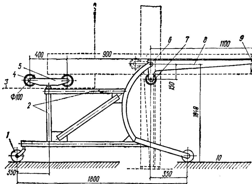
**Рис. 2. Тележка в момент установки колонны в монтажное положение**
