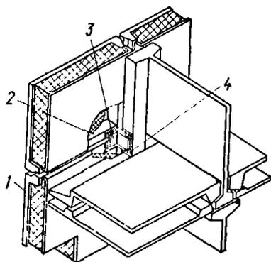
**Рис. 23. Усиление крепления навесных панелей продольных стен (вариант приварки новых связей) в домах серии ОД(К-7)**
