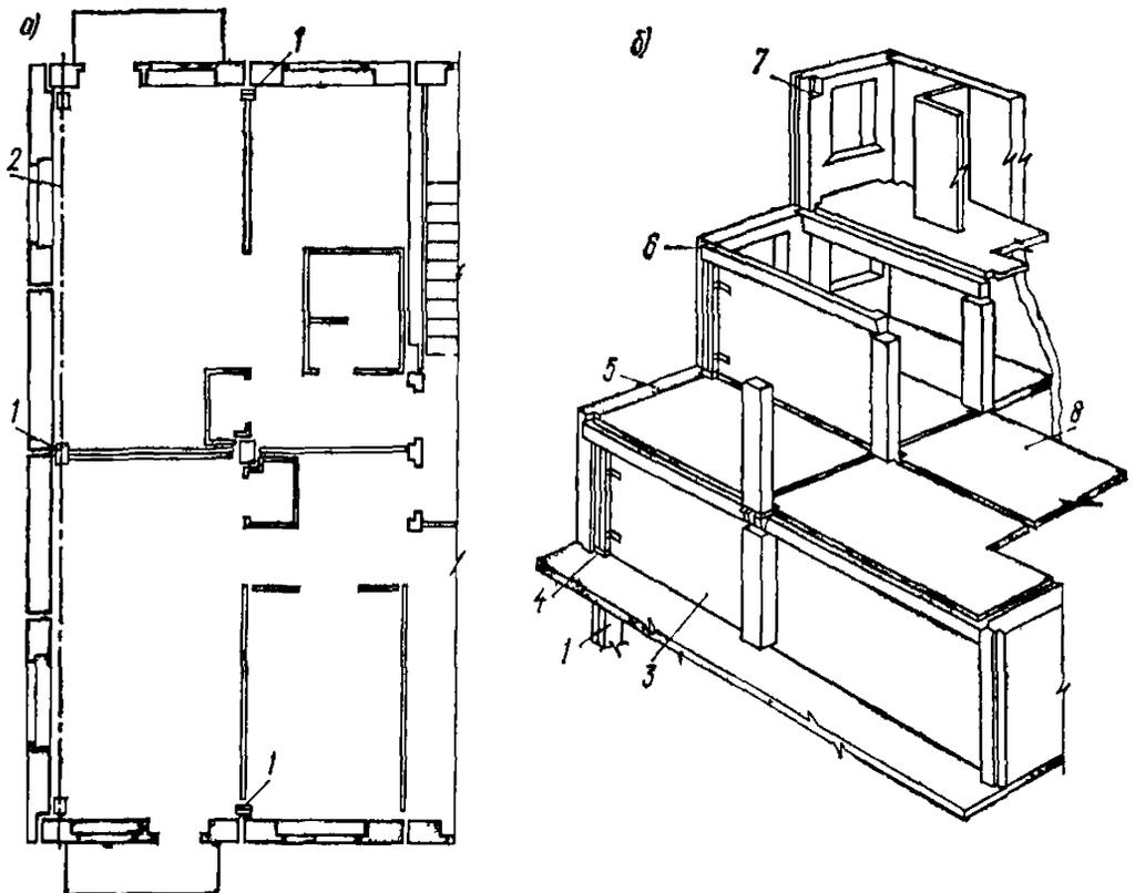
**Рис. 16. Усиление конструкции опирания перекрытия устройством пристенной
