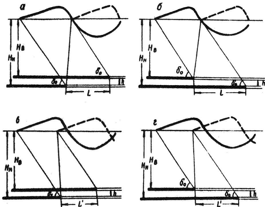
Рис. 12. Схема расположения очистных выработок в пластах для обеспечения взаимной компенсации деформаций.
