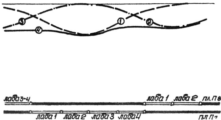
Рис. 9. Схема расположения горных выработок в двух пластах для образования плоского дна мульды сдвижения.
