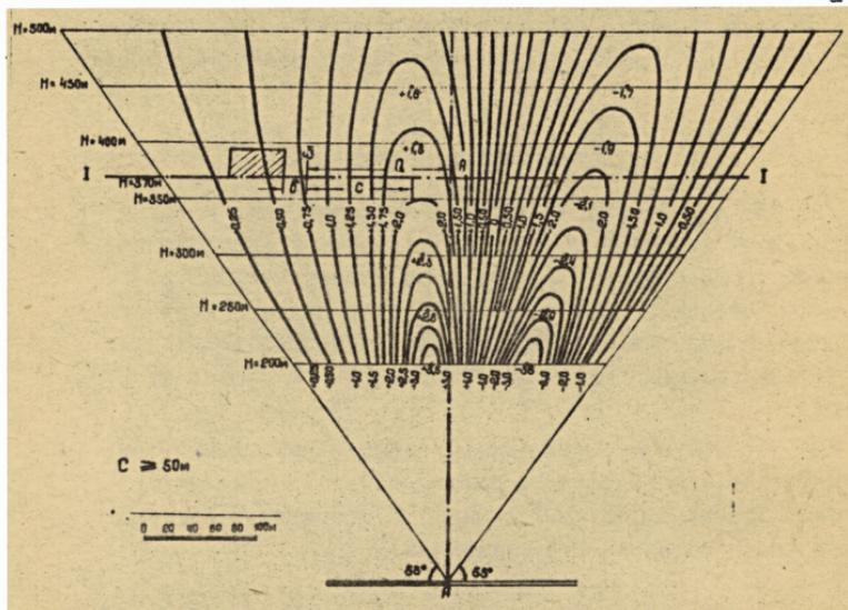
Рис. 2. Построение предохранительного целика по допустимым деформациям с помощью номограммы горизонтальных деформаций (изолинии выражены в  $1 \cdot 10^{-3}$ ).
