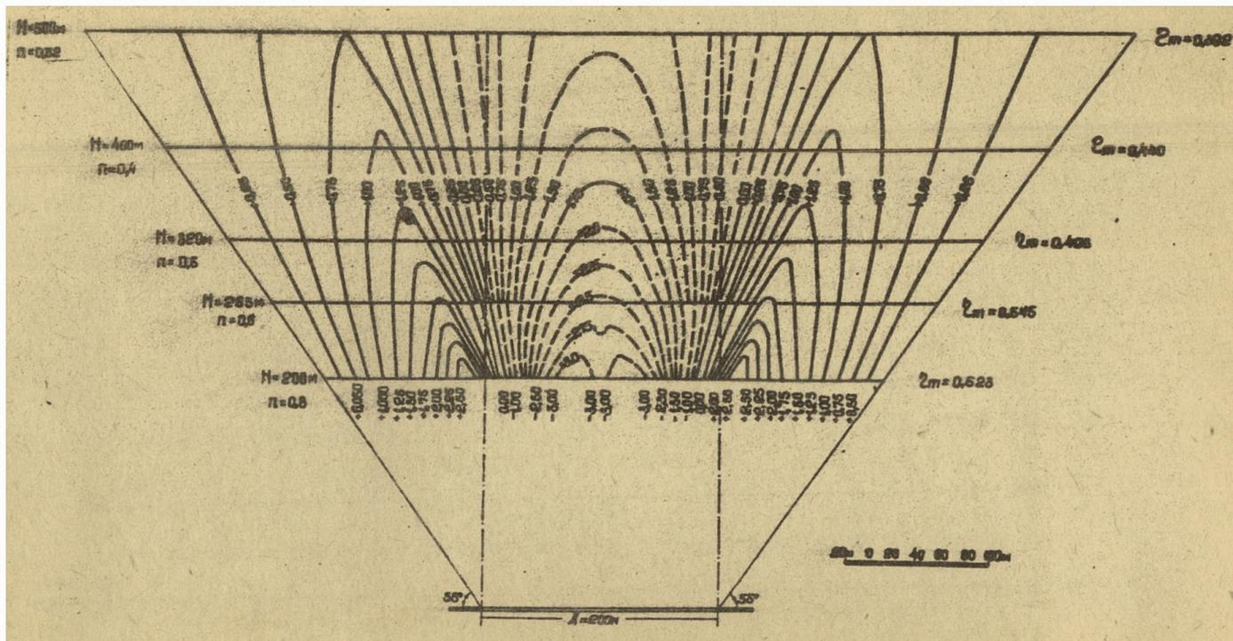
Рис. 18. Номограмма для определения горизонтальных деформаций при  $D = 200\text{ м}$ ;  $m = 1,0\text{ м}$ ;  $\alpha = 0^\circ$ .
