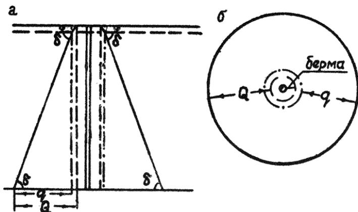
Рис. 1. Построение предохранительного целика:
