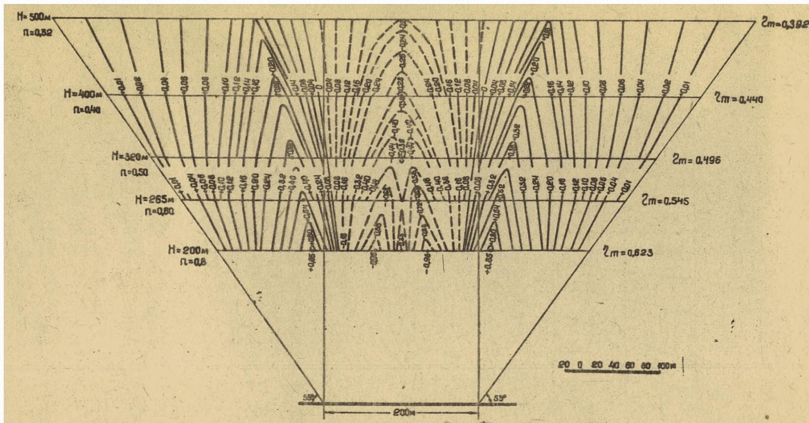
Рис. 19. Номограмма для определения кривизны при  $D = 200$  м;  $m = 1,0$  м;  $\alpha = 0^\circ$ .
