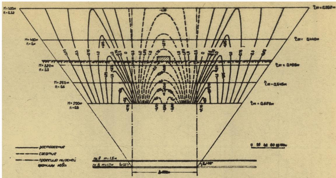
Рис. II. Схема выбора местоположения границы очистной выработки в пласте В, компенсирующей растяжение земной поверхности, вызываемое горными работами в пласте А (изолинии выражены в  $\text{I. IO}^\circ$ ).
