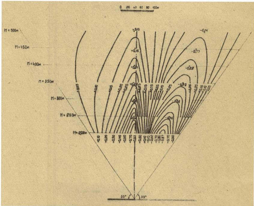
Рис. 24. Номограмма для определения кривизны в условиях полной поправки при  $m = 1,0$  м;  $\alpha = 0^\circ$  (изолинии выражены в  $1 \cdot 10^{-4}$  1/м).
