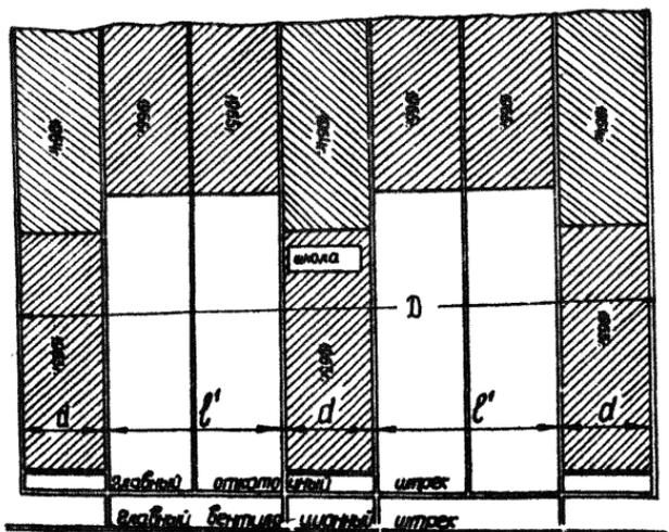
Рис. 8. Схема ведения горных работ под охраняемым объектом способом парных штреков.
