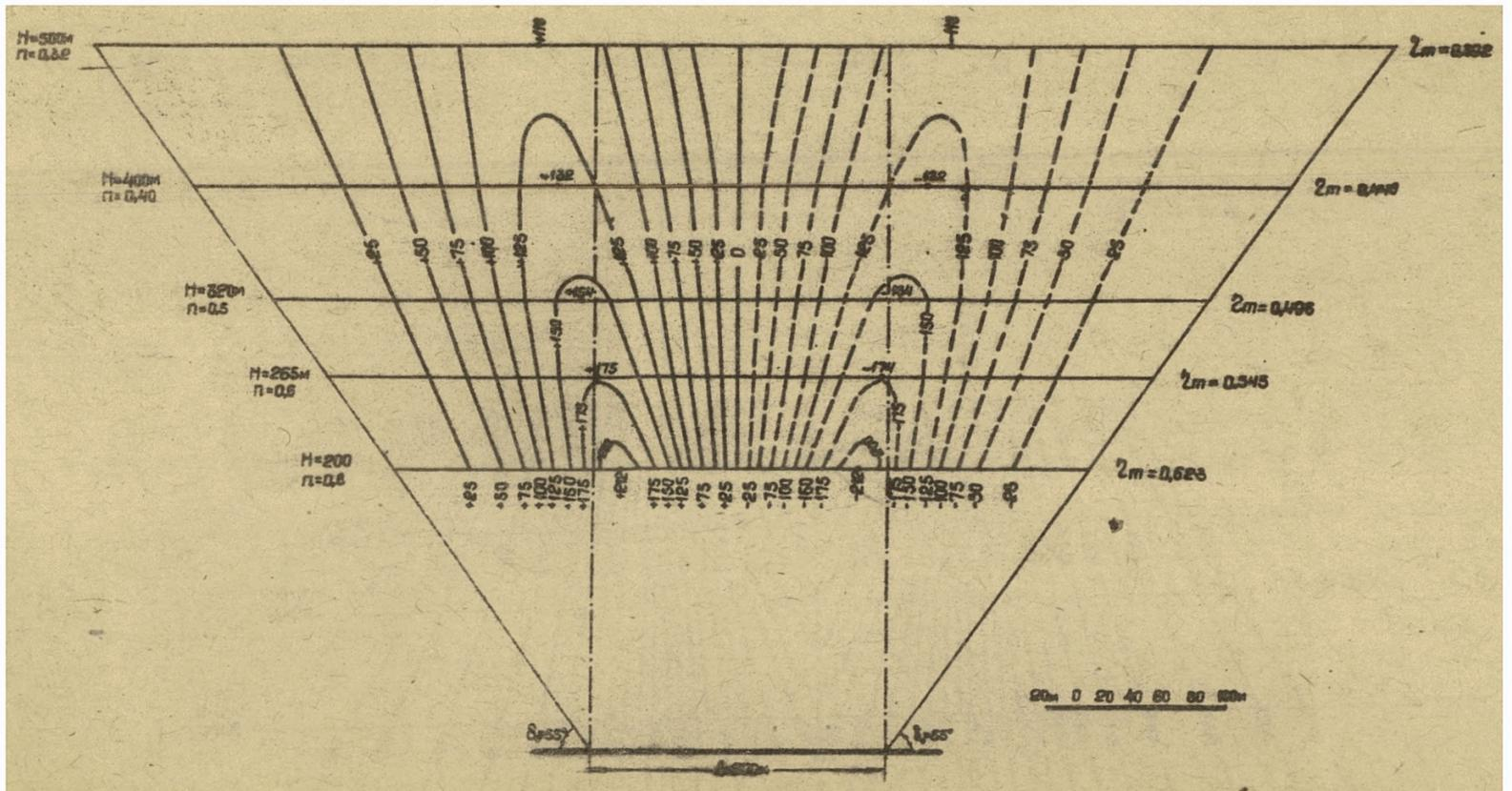
Рис. 16. Номограмма для определения горизонтальных сдвижений при  $D = 200$  м;  $m = 1,0$  м;
