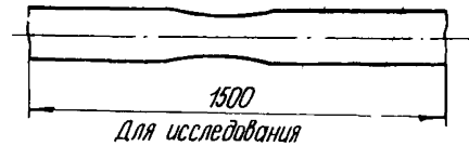
Рис.4. Смятие тела трубы
