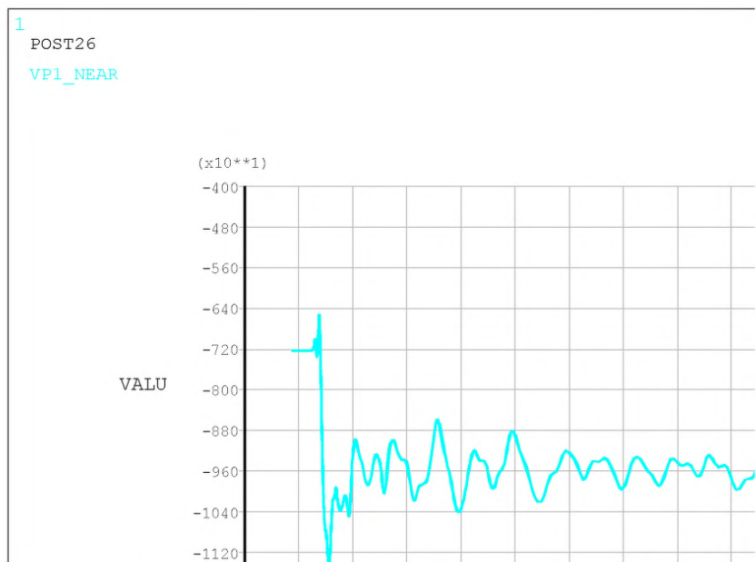
Рисунок IV.8.15 – Сценарий 1. Усилия в верхнем поясе ВП1 соседней фермы, кН (макс. -1150 кН)
