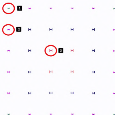
Рисунок IV.7.6 – Схема расположения удаляемых элементов (сценарии 1, 2 и 3)
