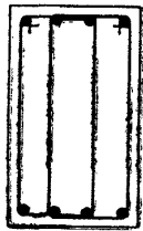
Рис. 9.6. Конструкция хомутов вязаных каркасов балок
