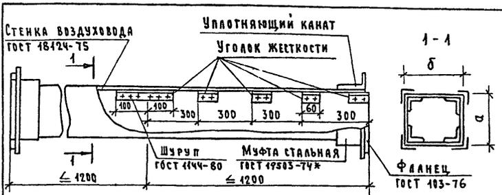
Асбестоцементные листы соединяются с помощью мастики из асбестоцементного раствора смешанного с казеиновым клеем и скрепляются уголками жесткости из алюминия. Продольные и поперечные швы проклеиваются двумя слоями ткани. Зазор между стальной муфтой и воздуховодом уплотняется пеньковым канатом, смоченным в казеиновом клее, а затем густым асбестоцементным раствором с добавлением казеинового клея. Смонтированные воздуховоды проверить на герметичность.
