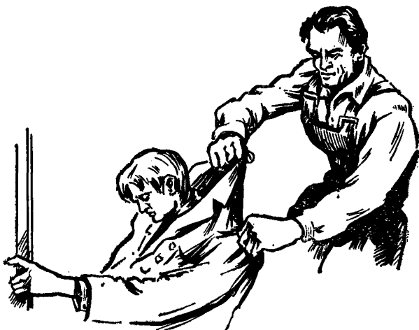
Рис. 3. Освобождение пострадавшего от тока в установках до 1000 В оттаскиванием за сухую одежду.
