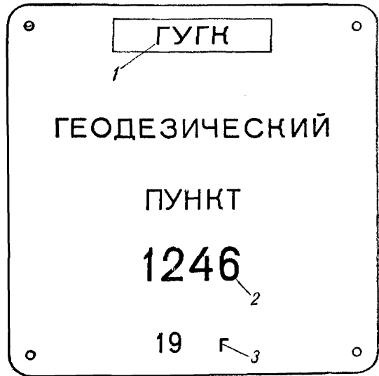
Рис. 25. Металлическая пластинка с номером геодезического пункта.
