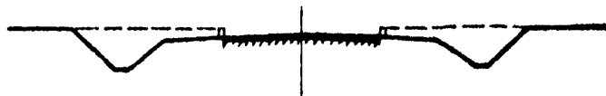
Рис.3. Поперечный профиль дороги с кюветом: _____ контур поперечного профиля 1-й очереди; - - - - - контур насыпки 2-й очереди
