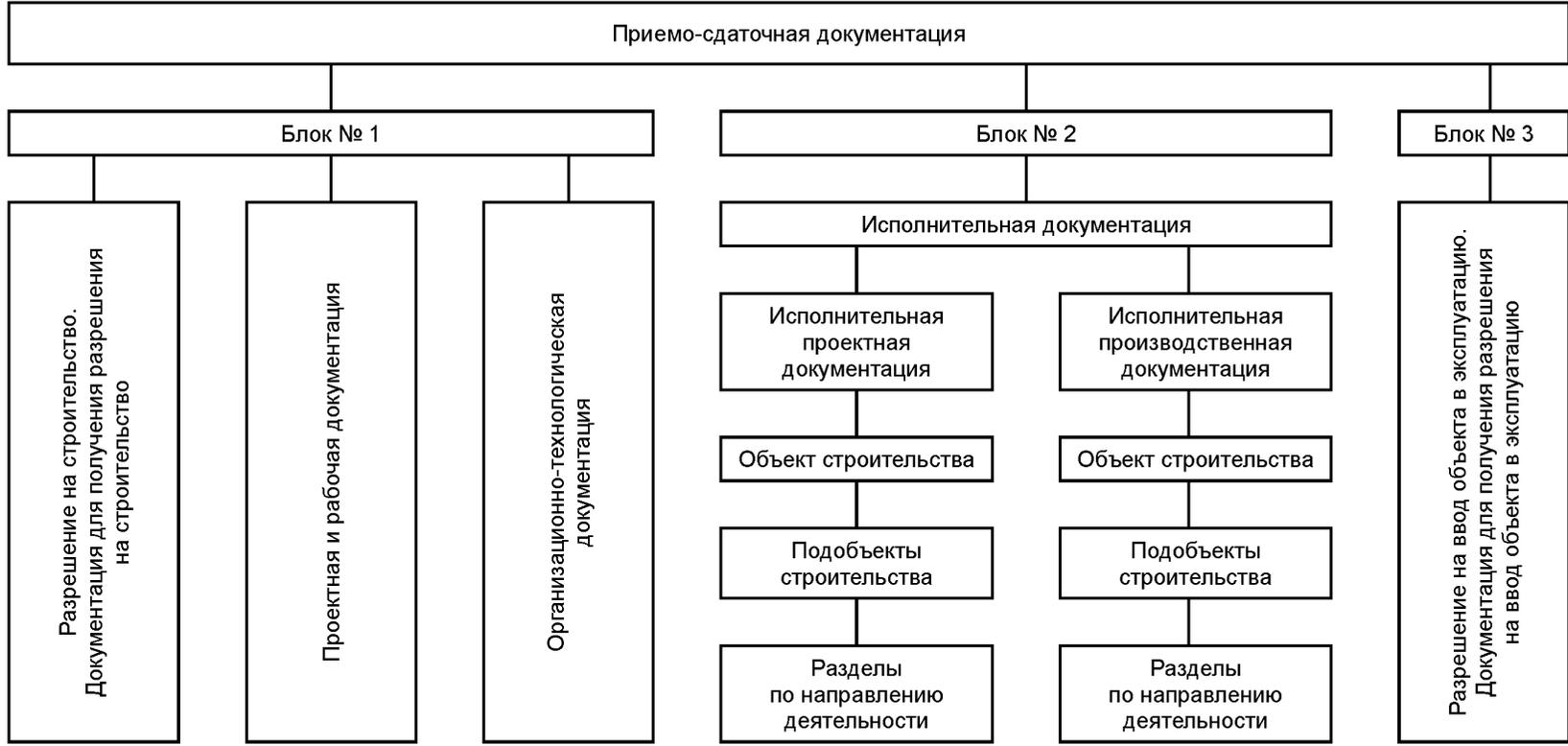
Рисунок 1 — Принцип формирования приемо-сдаточной документации
