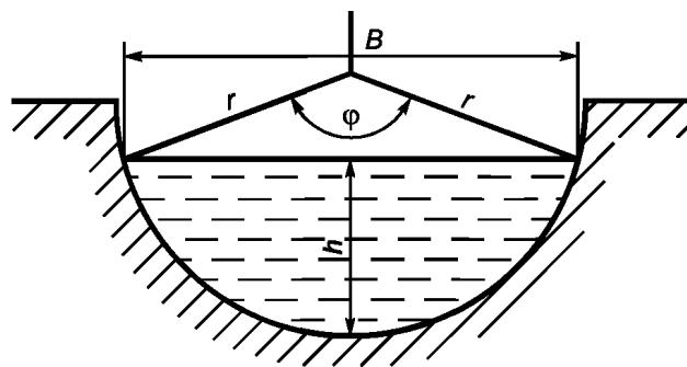
$B$  — ширина поверху;  $h$  — глубина воды в канале;  $r$  — радиус живого сечения;  $\phi$  — центральный угол сечения
