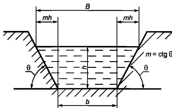
$B$  — ширина поверху;  $b$  — ширина канала по дну;  $h$  — глубина воды в канале;
