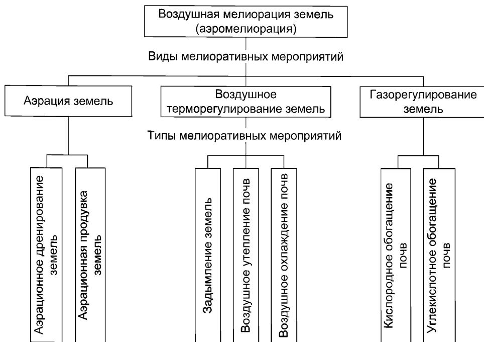
Рисунок А.13 — Классификация по видам и типам мелиоративных мероприятий воздушной мелиорации земель (аэромелиорации)
