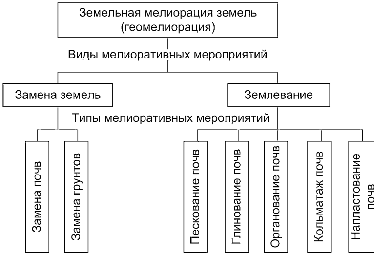
Рисунок А.3 — Классификация видов и типов мелиоративных мероприятий земельной мелиорации земель (геомелиорации)
