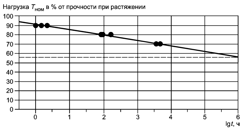
Рисунок Б.4 — Зависимость приложенной нагрузки от времени до разрыва Значение коэффициента k_2 округляют до двух значащих цифр: k_2 = 1,78 .
