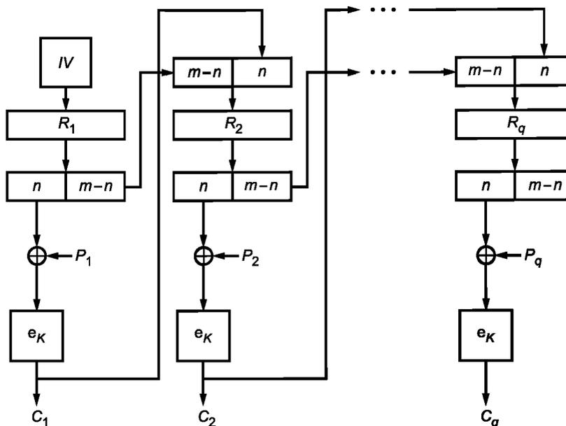
Рисунок 7 — Зашифрование в режиме простой замены с зацеплением
