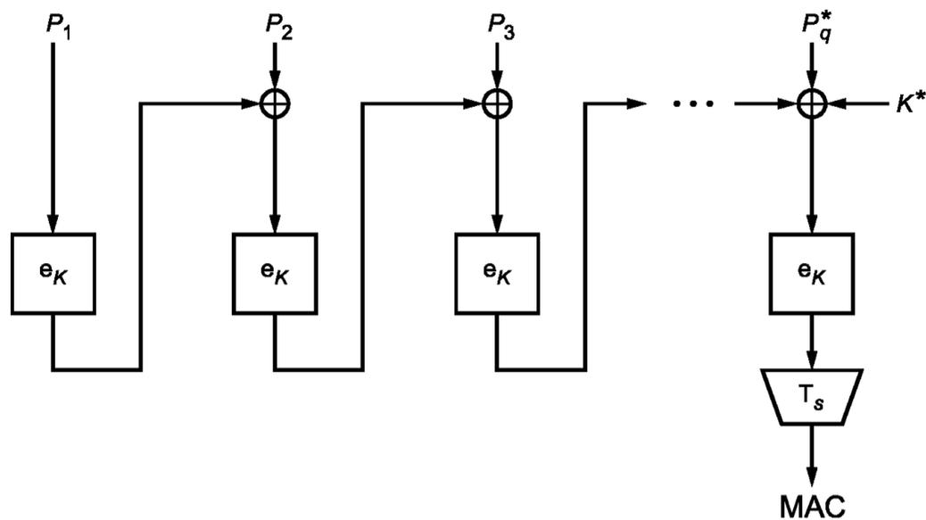
Рисунок 11 — Вычисление значения имитовставки — общий вид
