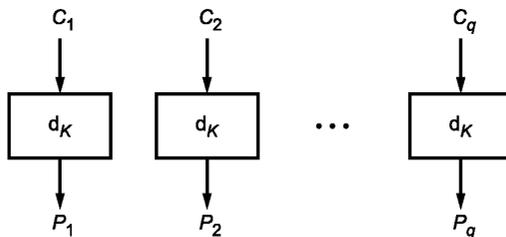
Рисунок 2 — Расшифрование в режиме простой замены
