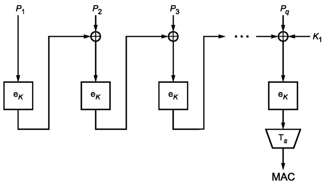
Рисунок 12 — Вычисление значения имитовставки — случай полного последнего блока
