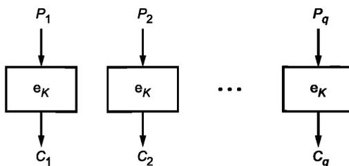
Рисунок 1 — Зашифрование в режиме простой замены
