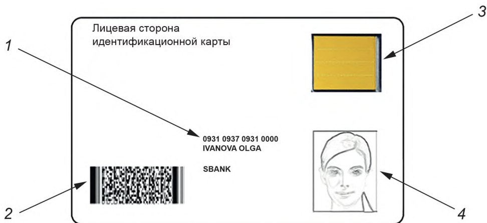
1 — печатная информация; 2 — 2D-штрихкод; 3 — биометрический сканер; 4 — изображение
