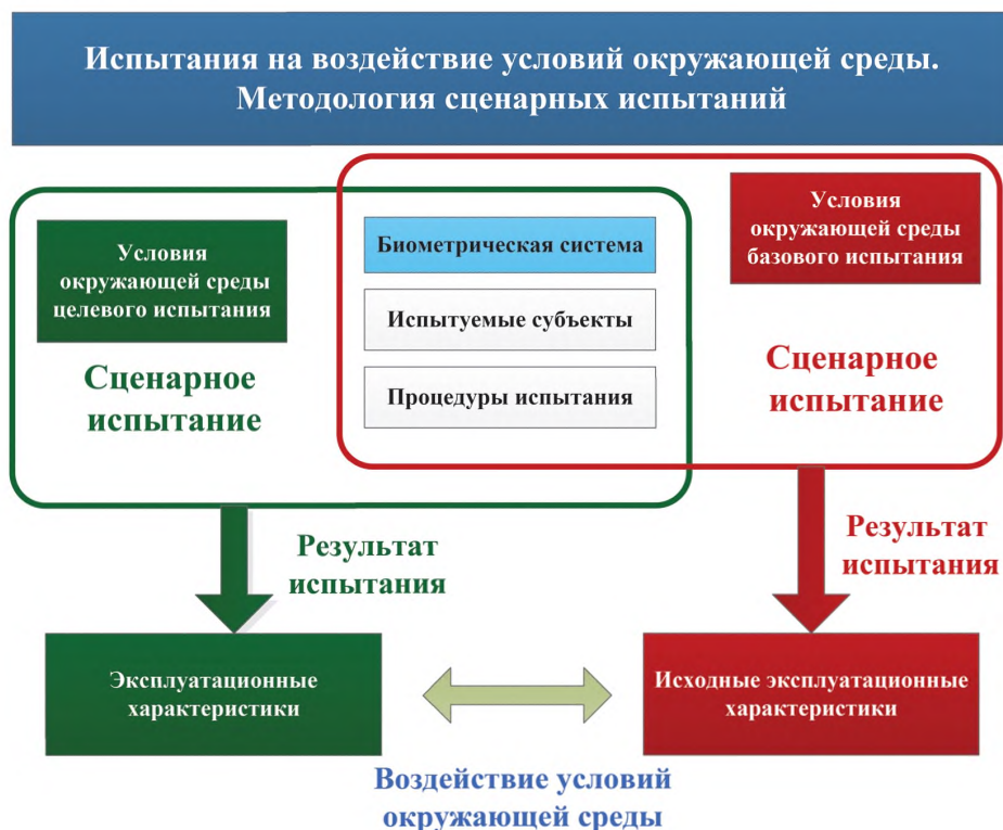
Рисунок 1 — Схема методологии сценарного испытания
