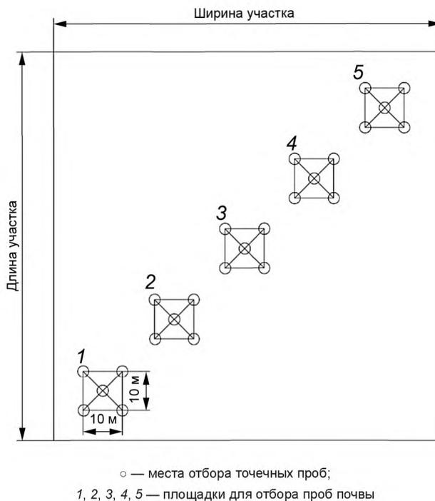
Рисунок 1 — Схема размещения площадок для отбора проб почвы
