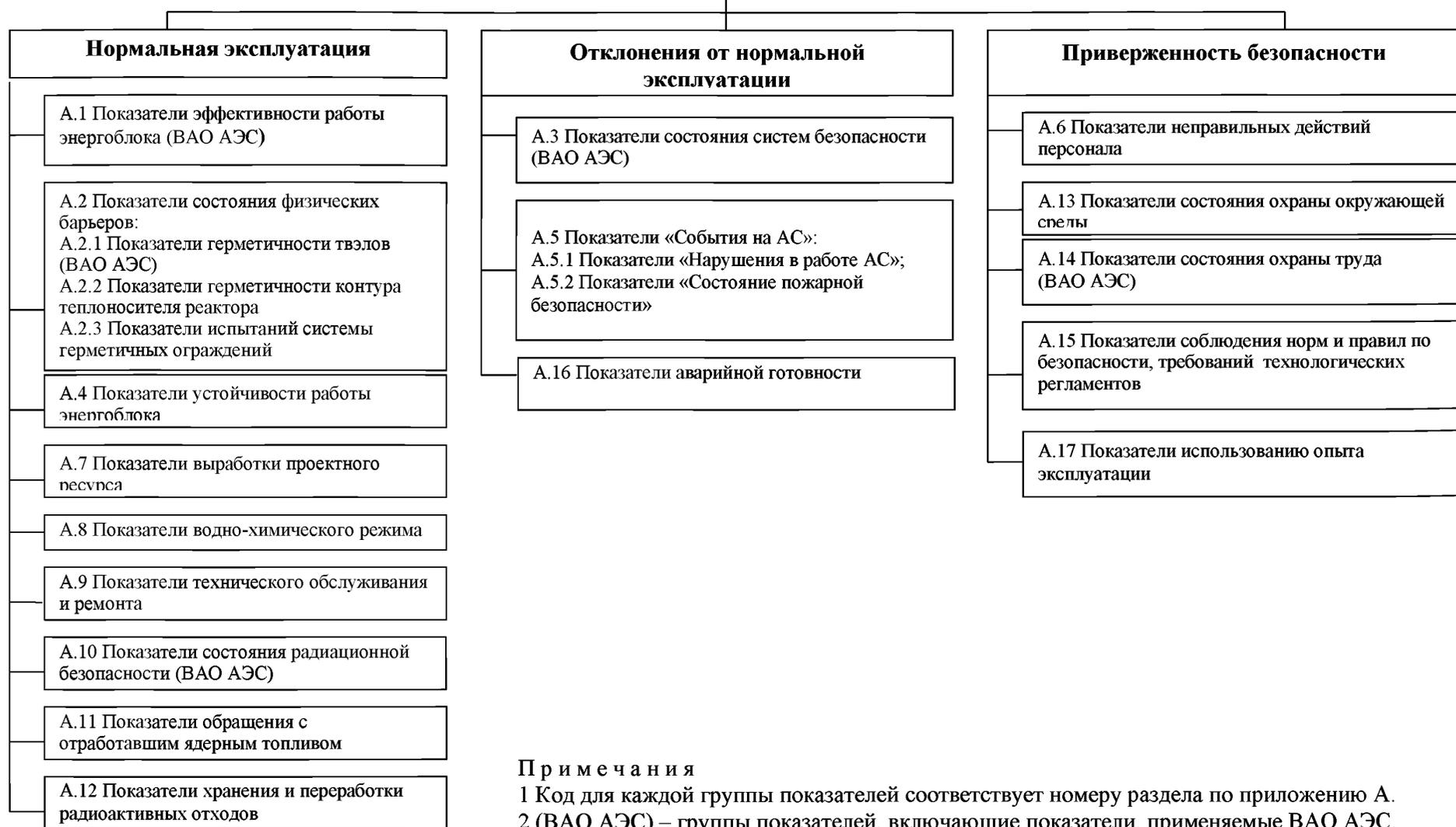
Рисунок 1 - Структура системы показателей безопасной эксплуатации энергоблоков АС
