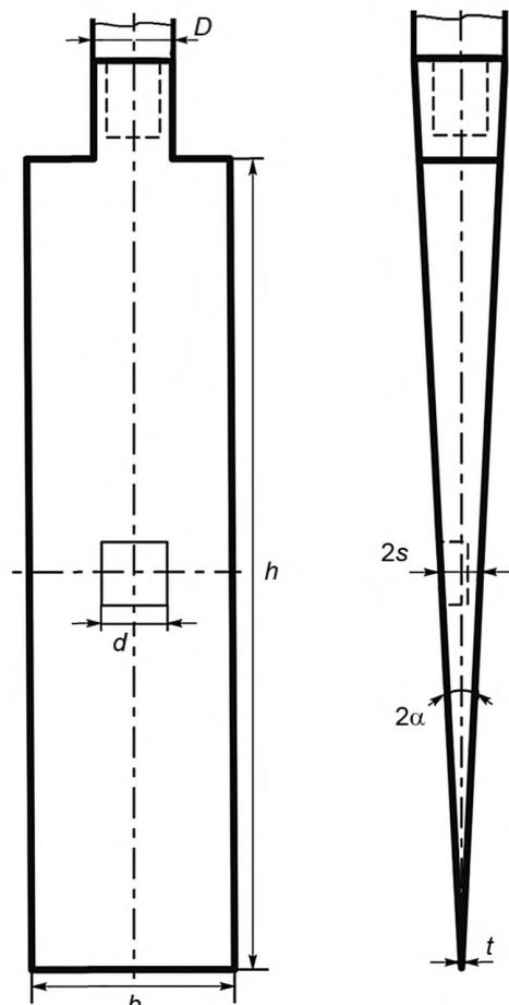
$h$  — расчетная длина рабочей грани;  $b$  — ширина рабочей грани;  $t$  — толщина режущей кромки;  $2\alpha$  — угол раскрытия клина;  $d$  — ширина (диаметр) датчика давления;  $D$  — диаметр штанг;  $2s$  — толщина клина по центру датчика давления, равная перемещению грунта, задаваемому рабочими гранями расклинивающего дилатометра
