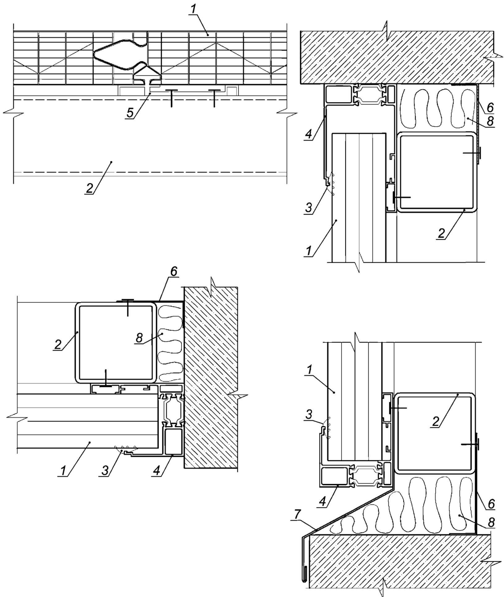
1 — модульная поликарбонатная панель; 2 — элемент металлического каркаса; 3 — уплотнитель; 4 — алюминиевый профиль;
