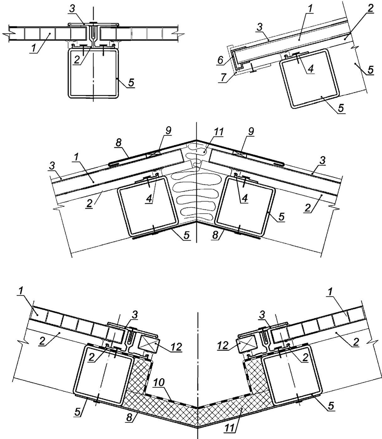
1 — поликарбонатная панель; 2 — базовый алюминиевый профиль с резиновым уплотнителем; 3 — прижимной алюминиевый профиль с резиновым уплотнителем; 4 — алюминиевый профиль с резиновым уплотнителем; 5 — элемент металлического каркаса; 6 — торцевой профиль; 7 — фиксатор торцевого профиля; 8 — фасонный металлический элемент; 9 — уплотнитель; 10 — ПВХ-мембрана; 11 — утеплитель; 12 — проставка
