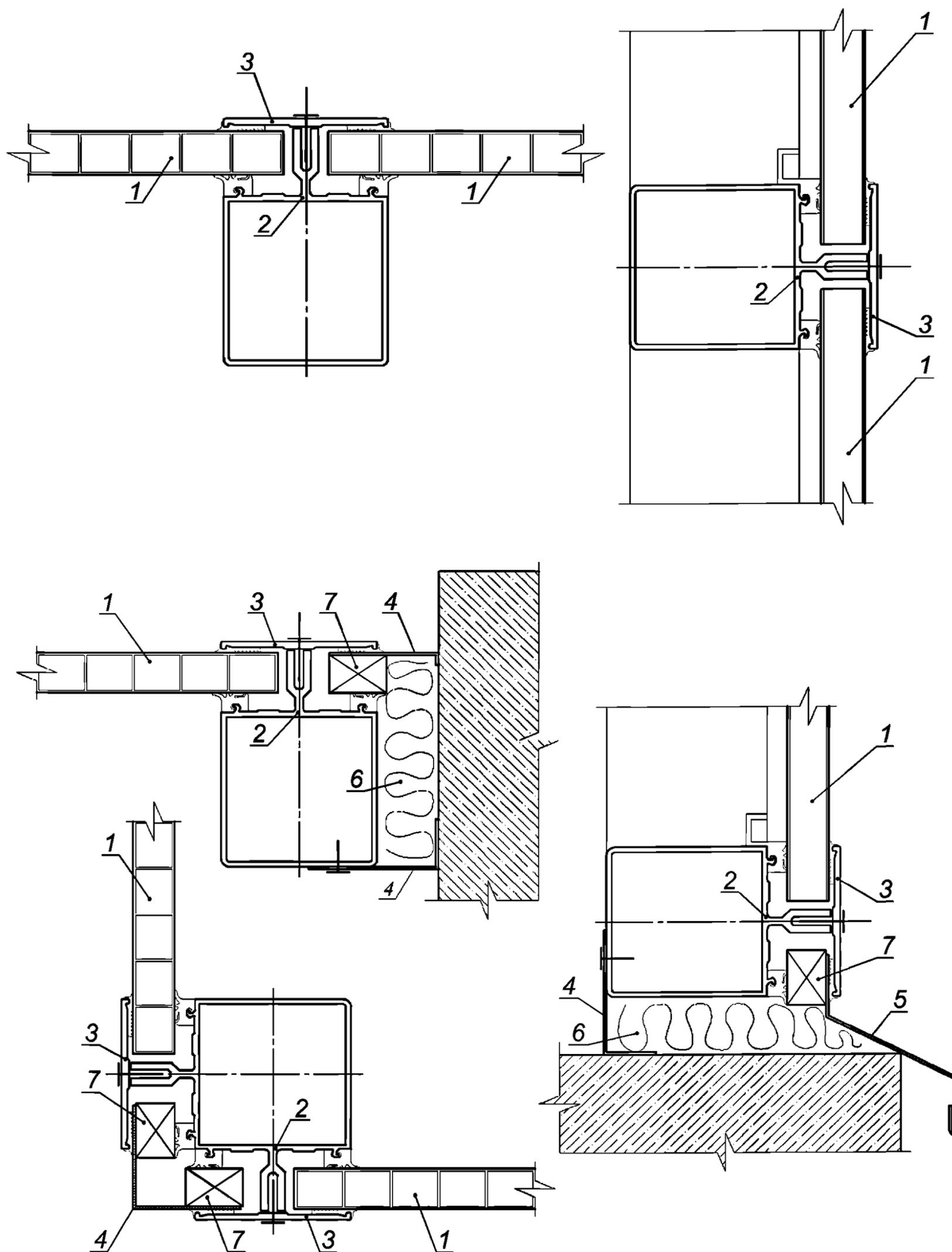
1 — поликарбонатная панель; 2 — базовый алюминиевый профиль с резиновым уплотнителем; 3 — прижимной алюминиевый профиль с резиновым уплотнителем; 4 — фасонный металлический элемент, 5 — отлив; 6 — утеплитель; 7 — проставка
