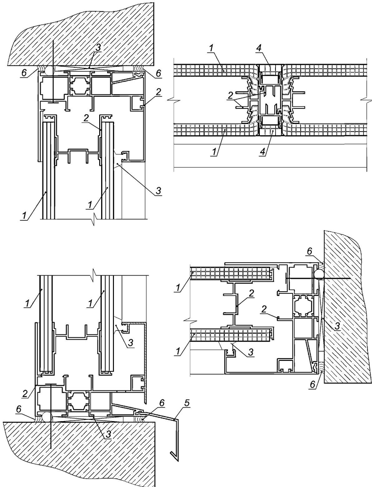
1 — поликарбонатная панель; 2 — алюминиевый профиль; 3 — уплотнитель; 4 — поликарбонатная вставка; 5 — отлив; 6 — герметик
