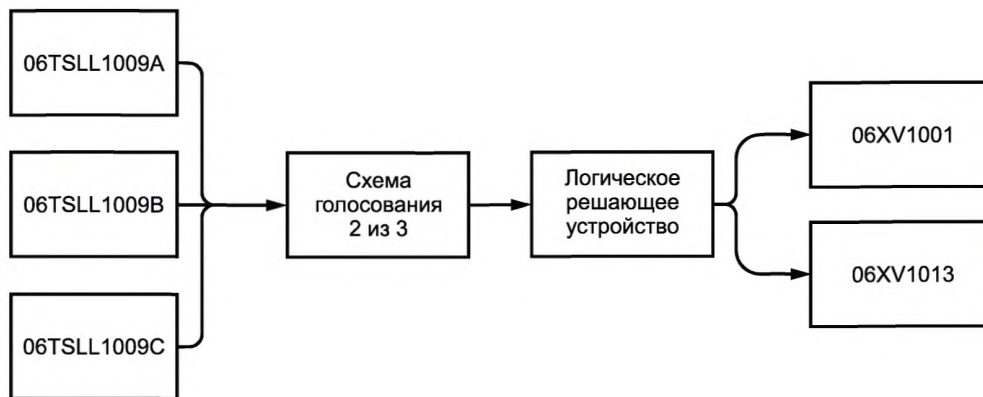
Рисунок В.5 — Функциональная архитектура аппаратных средств ФБ ПСБ 06.02
