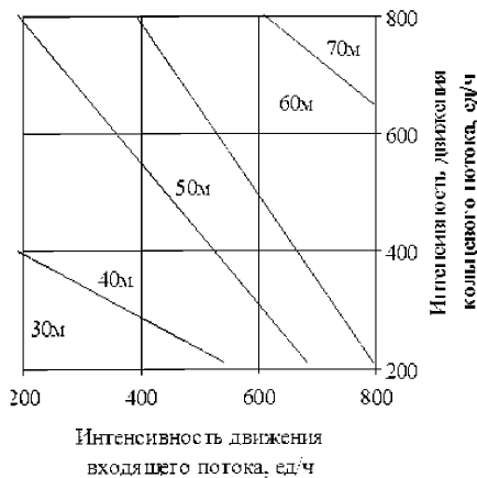
Рисунок 1.11 - Номограмма выбора минимально необходимой длины участка переплетения при расчётной скорости движения 40 км/ч
