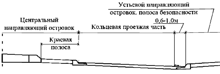
Рисунок 1.19 - Параметры и схема устройства краевых полос
