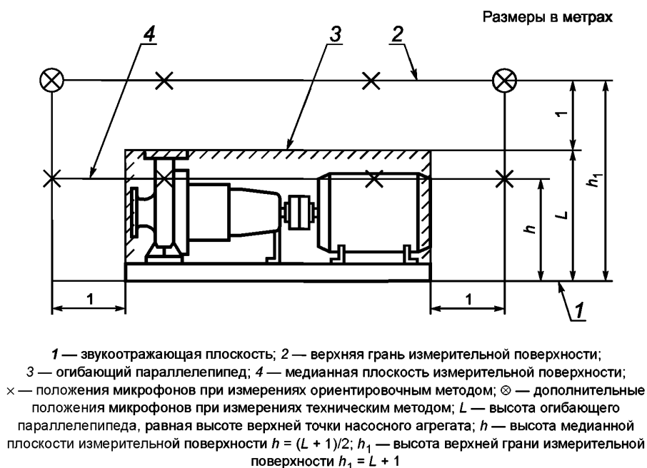
Рисунок 3 — Типовая измерительная поверхность и плоскости, в которых измеряют уровни звукового давления насосного агрегата
