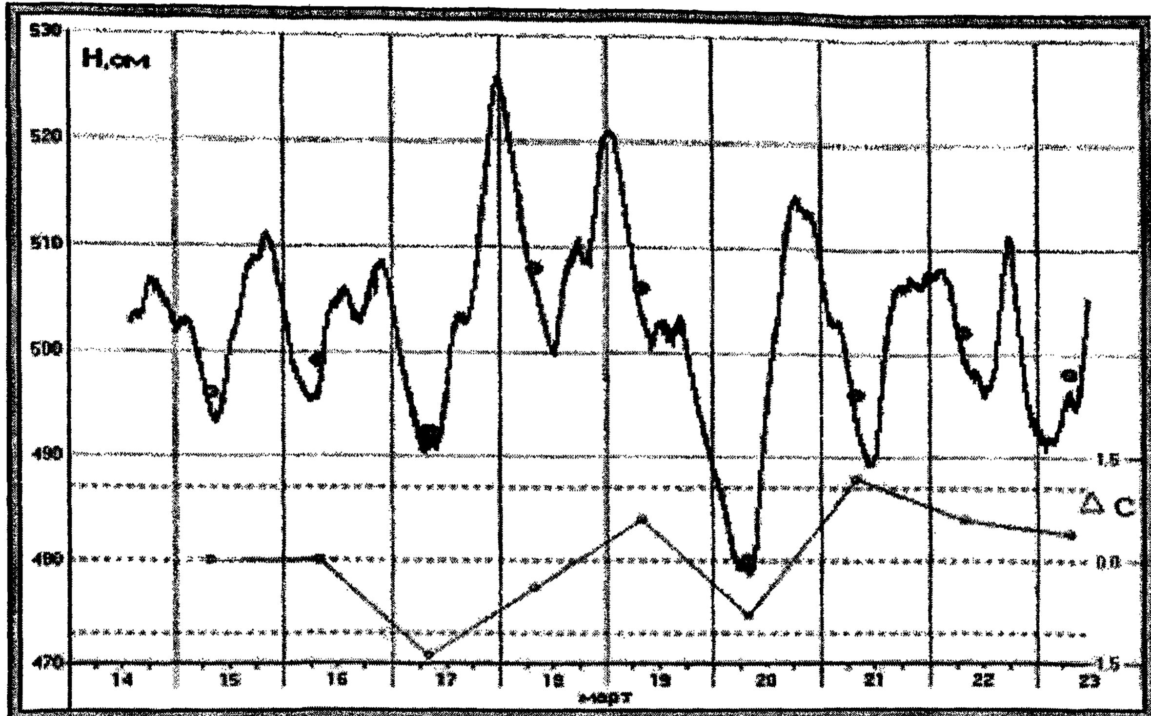
Рисунок 5.6 — Комплексный график хода уровня по данным записи УПЦ и контрольных измерений уровня воды и хода отклонений поправки  $\Delta C_1$ .
