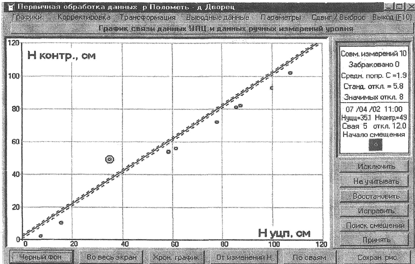
Рисунок 5.5 — График связи  $H_{\text{контр}} = f(H_{\text{уцп}})$ .
