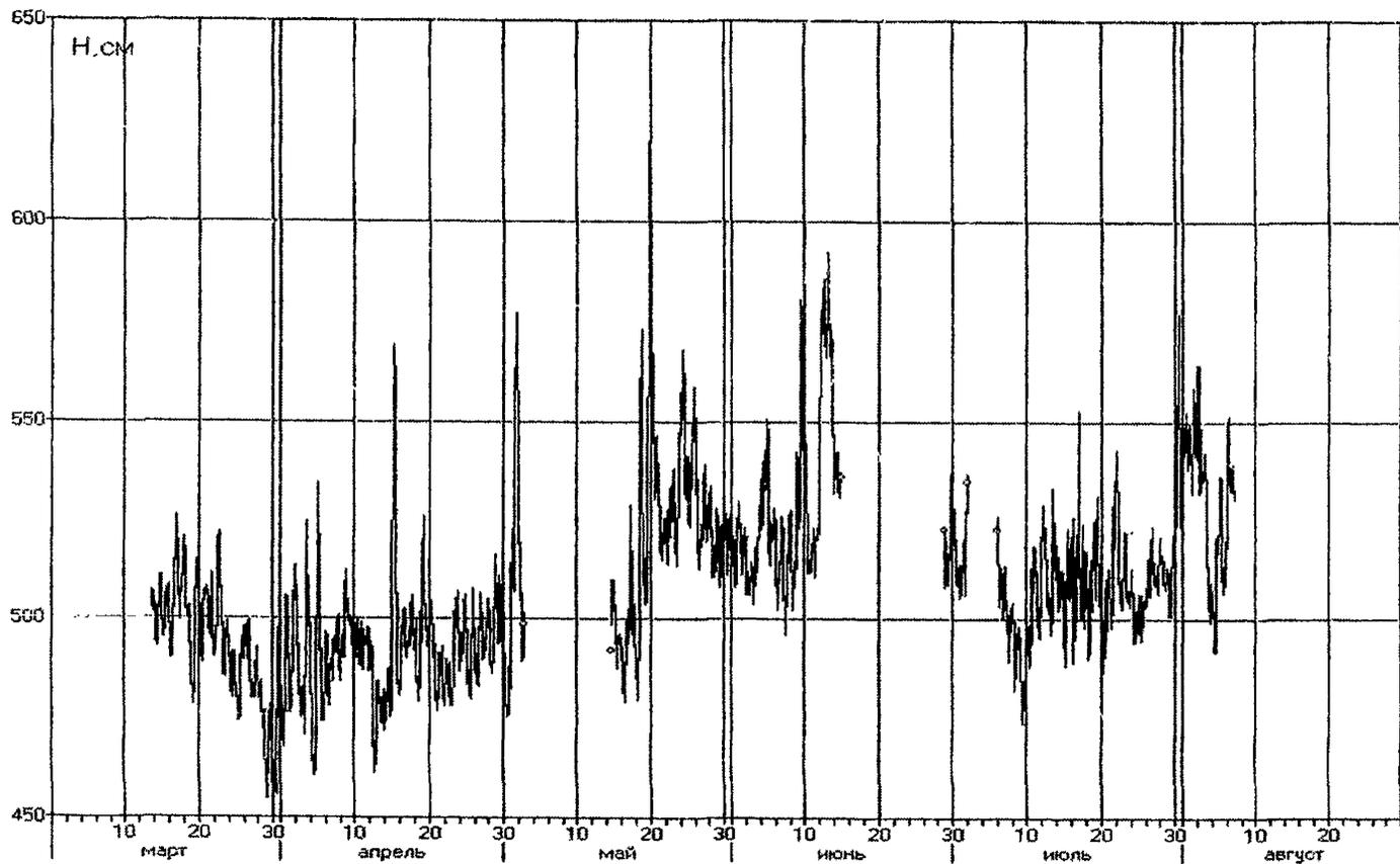
Рис 5.12 — Ход среднесуточных уровней воды р.Невы у Горного института, наблюдаемых при помощи УЩС с марта по август 2001 г. (кружками отмечены начало и конец интервалов кратковременных пропусков в наблюдениях, разрыв линии хода уровней соответствует длительным пропускам в наблюдениях).
