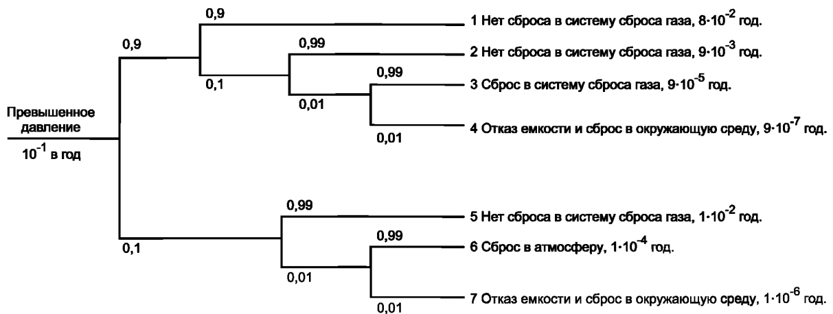
Рисунок В.4 — Опасные события для функции безопасности ПСБ с УПБ 2
