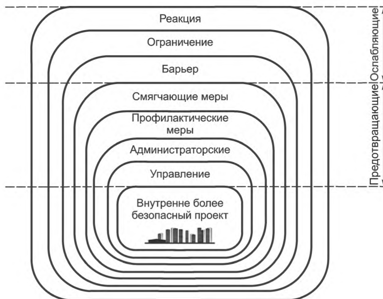
Рисунок G.1 — Графическое представление слоев защиты, показывающее предотвращающие и ослабляющие НСЗ
