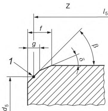
1 — точка замера;  $g$  — длина фаски наружной кромки;  $f$  — длина наружной кромки;  $l_5$  — контрольная длина;  $d_5$  — контрольный диаметр
