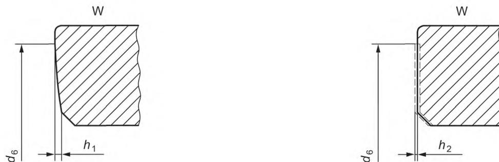
а) Вогнутость торцевой поверхности
