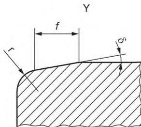
$r$  — радиус скругления наружной кромки;  $f$  — длина наружной кромки;  $\delta$  — угол дополнительного скоса наружной кромки
