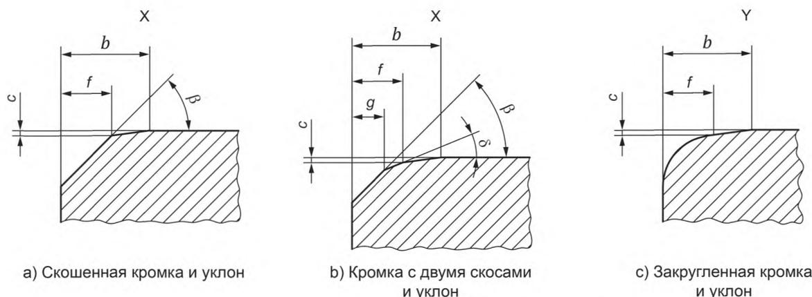
$b$  — длина уклона наружной кромки;  $c$  — высота уклона наружной кромки;  $g$  — длина фаски наружной кромки;  $f$  — длина наружной кромки;  $\delta$  — угол дополнительного скоса наружной кромки;  $\beta$  — угол скоса наружной кромки
